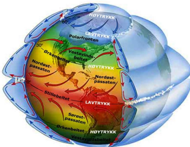
Figur 3: Prinsippskisse som viser det globale vindsystemets sirkulasjon (Naturfag for alle, u.å.).
