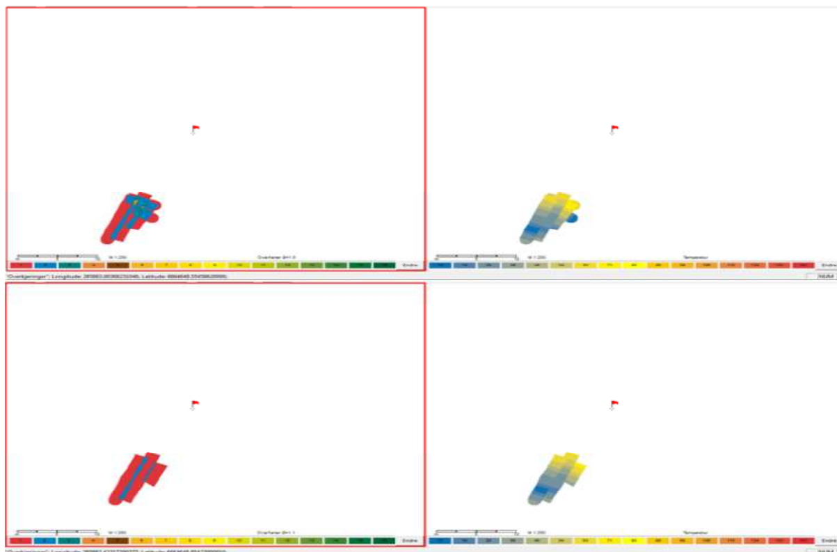
Figur 93 Overførte fra Hamm utført mellom 10 og 80 grader °C. Øverst V. Ser man antall overførte med vibrasjon, øverst H. viser temperatur ved siste overfart med vibrasjon. Nederst V. ser man antall overførte utført med oscillasjon og nederst H. vises temperatur ved siste overfart med oscillasjon.
