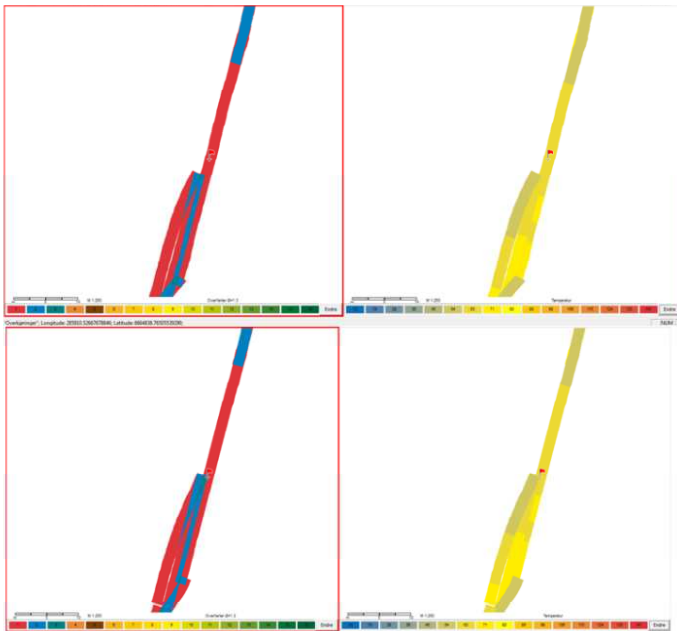
Figur 84 Overfarter fra Hamm utført mellom 10 og 80 grader °C. Øverst V. Ser man antall overfarter med vibrasjon, øverst H. viser temperatur ved siste overfart med vibrasjon. Nederst V. ser man antall overfarter utført med oscillasjon og nederst H. vises temperatur ved siste overfart med oscillasjon.
