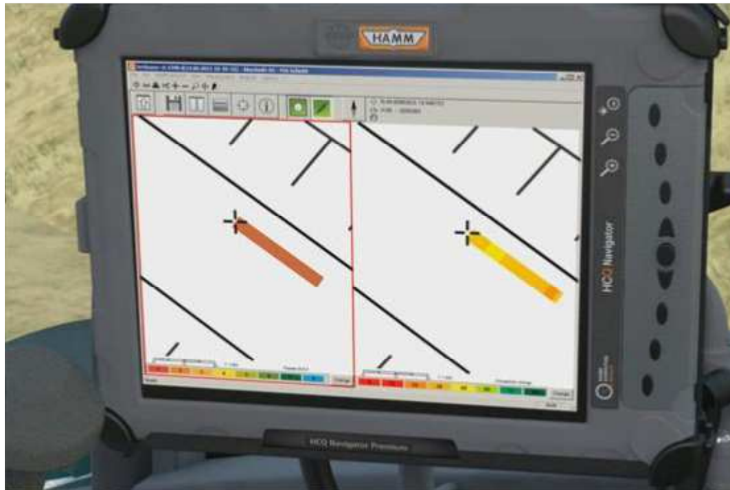
Figur 24 Viser displayet hos valseføringen hvor han kan se to parametere til samme tid. Her er det vist antall overfarter og temperatur. (Hamm 2014b)
