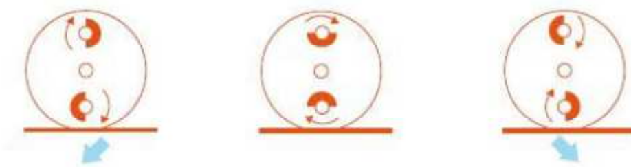
Figur 11 Viser oscillasjonsprinsippet til valsene levert fra Hamm.(Hamm 2014b)
