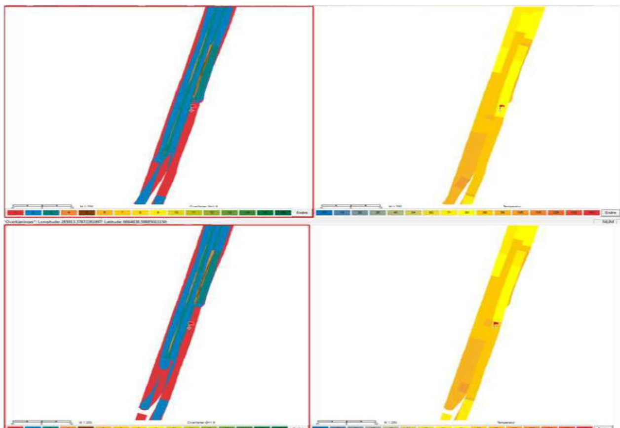
Figur 83 Overfarter fra Hamm utført mellom 80 og 150 grader °C. Øverst V. Ser man antall overfarter med vibrasjon, øverst H. viser temperatur ved siste overfart med vibrasjon. Nederst V. ser man antall overfarter utført med oscillasjon og nederst H. vises temperatur ved siste overfart med oscillasjon.
