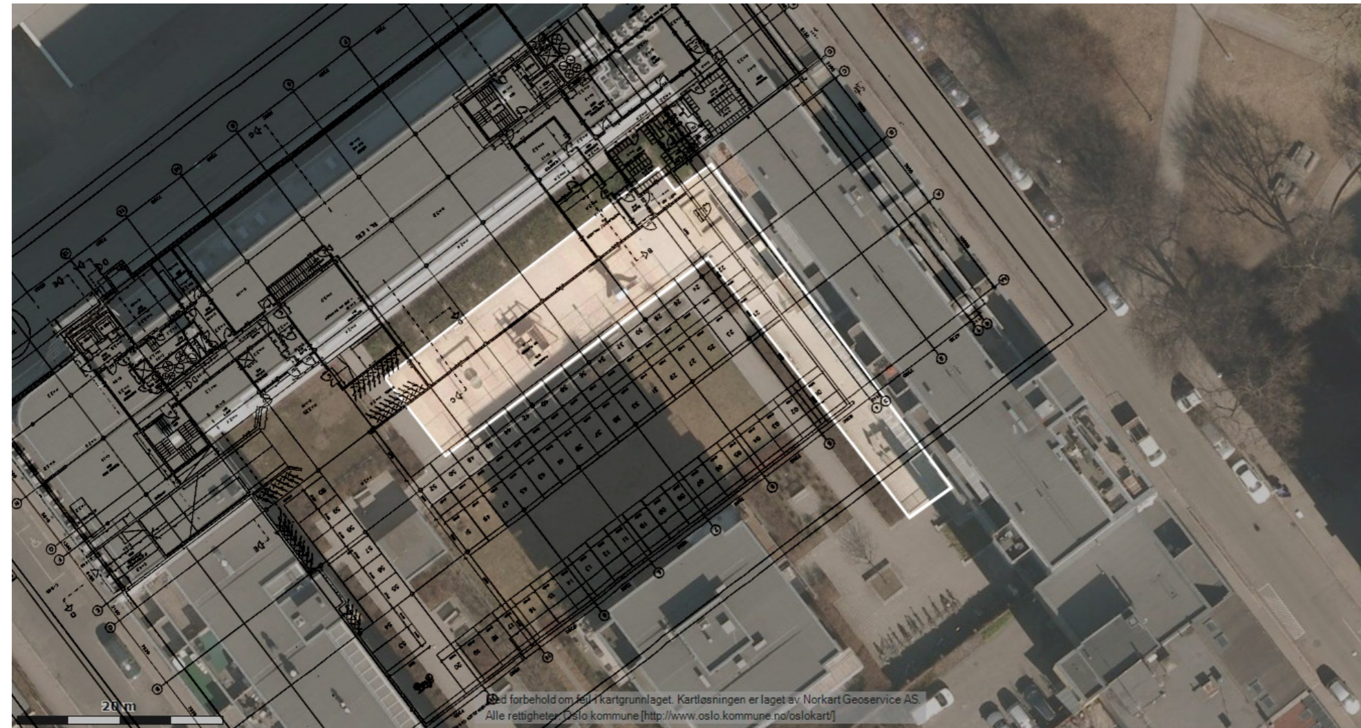
Figur 65. Bildet over viser hvordan plan og bygningsetatens kjeller strekker seg langt inn på bygårdens fellesområder.
