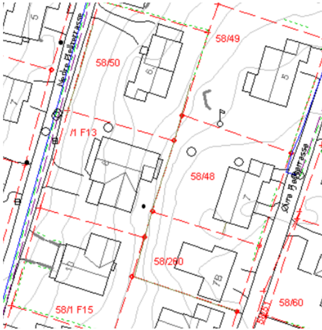
Figur 7. Oversiktskart med registrerte VA-ledninger (Tønsberg kommune 2014c).
