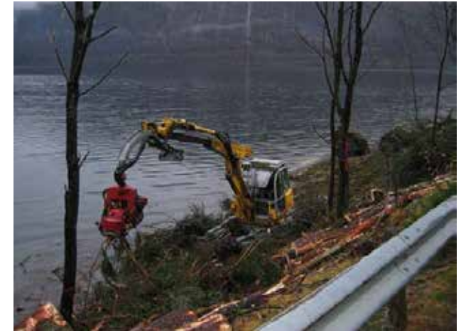
Bilde 11: Maskinell rydding med hogstmaskinen Menzi Muck. Bildet er hentet fra rapporten Kulturlandskap og Attgroing, s. 20, Bildet er tatt av Nordheim.
