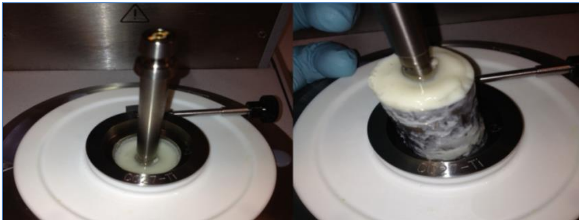
Bilde 4.13. Bob-cup geometri med gel til venstre. Svak gel etter oscillerende amplitudesveip til høyre (Even Gausemel)
