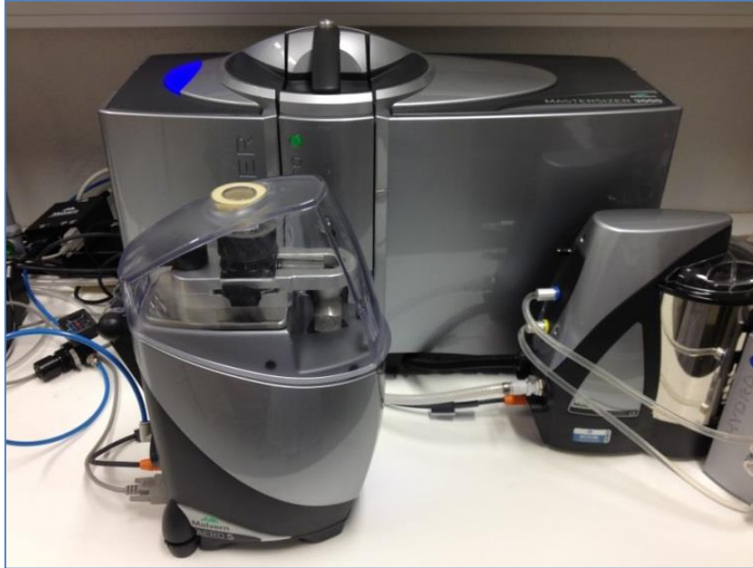
Bilde 4.16. Malvern Mastersizer partikkelmåler med tørrdispersjonsenhet i forkant (Even Gausemel)
