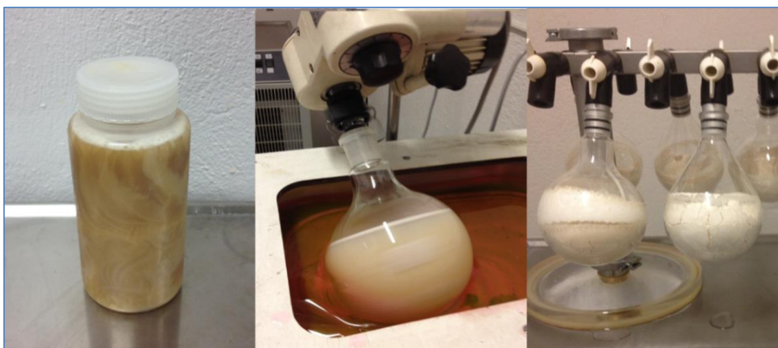
Bilde 4.9 Frossent konsentrat til venstre, alkoholfryser midstilt og vakuumfrysetørke til høyre (Even Gausemel)
