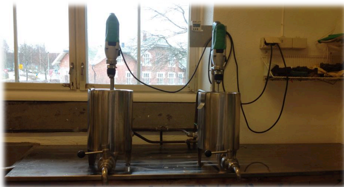
Bilde 1: Prosessbeholdere (5L), av rustfritt stål med doble vegger med steam- og isvanntilkopling, benyttet under varmebehandling
