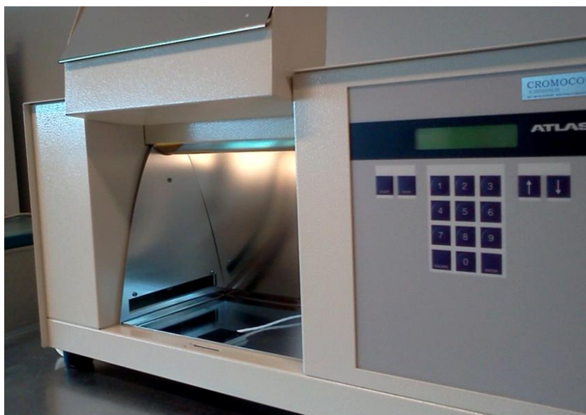
Figur 3.2.1: Bilde av Atlas Suntest CPS+ med kontrollpanel og åpent prøvekammer.
