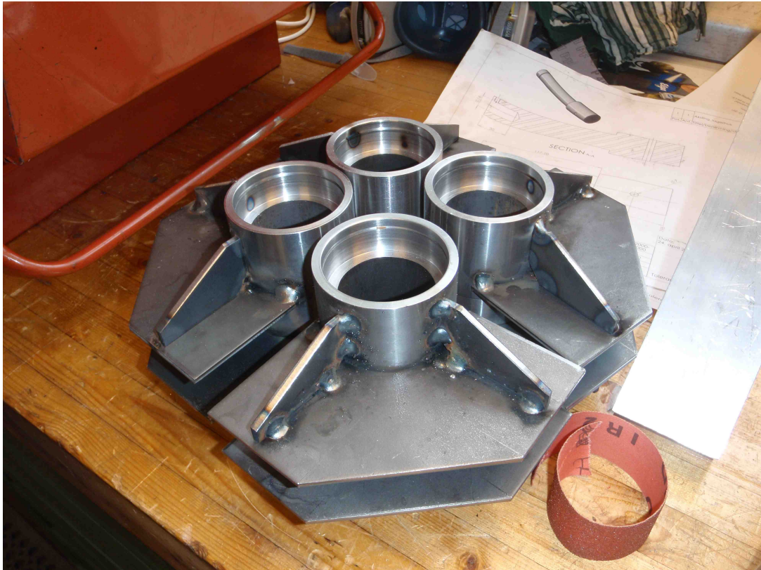
Figur 54: De fire kulelagerhusene med påsveiset plater. Foto Fredrik Blomberg.
