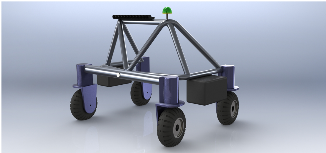
Figur 13: Konsept med vippepunkt for bedre fremdriftsegenskaper.
