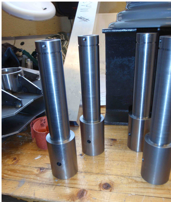
Figur 55: Akslingen mellom servogiret og underarmen. Foto Fredrik Blomberg.
