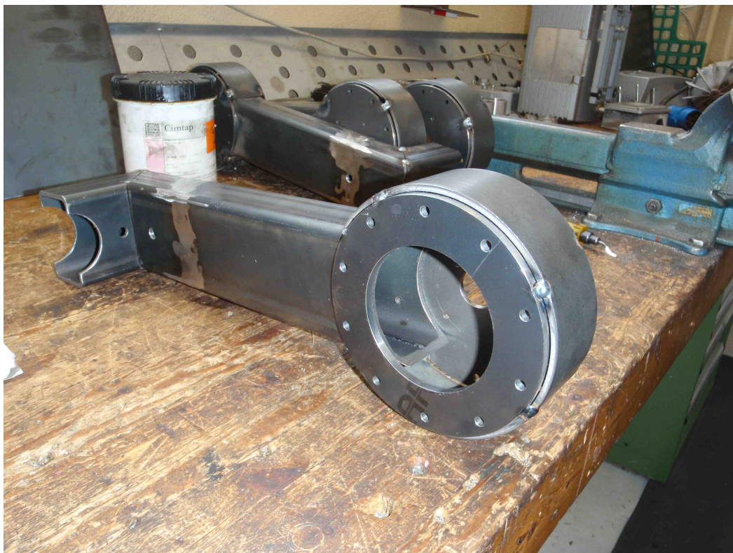
Figur 51: Delene blir punktsveiset sammen for å se om sammenstillingen passer. Når samtlige deler passer sammen kan delene helstveises. Her er underarmen avbildet. Foto Fredrik Blomberg.
