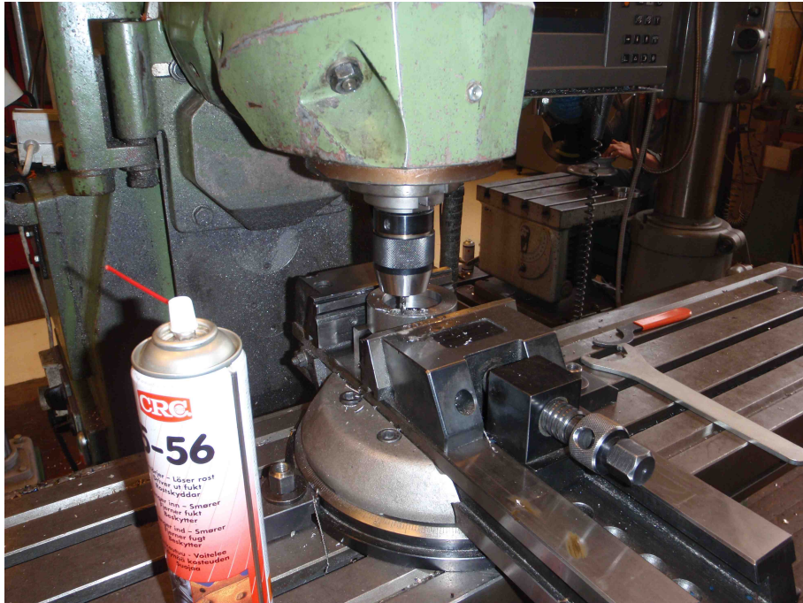
Figur 50: Delen som er spent fast i stikka er ringen som fester servogiret. Her freses skruerullene til monteringskruene. Foto Fredrik Blomberg.
