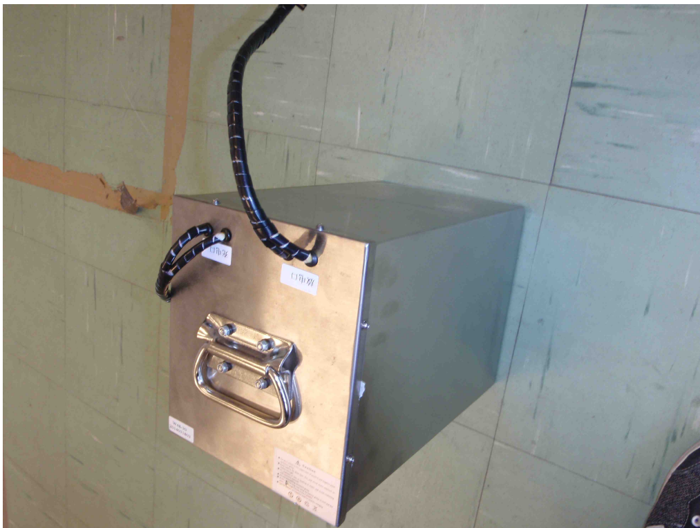
Figur 57: Batteriet som ble kjøpt fra et firmaet Golden Motors fra Kina. I et av batteriene var ledningene feilkoblet. Når batteriet ble koblet til laderen lignet det en kortslutning. Koblingsfeilen førte til at polene i laderen brant bort i løpet av sekunder. Foto Fredrik Blomberg.
