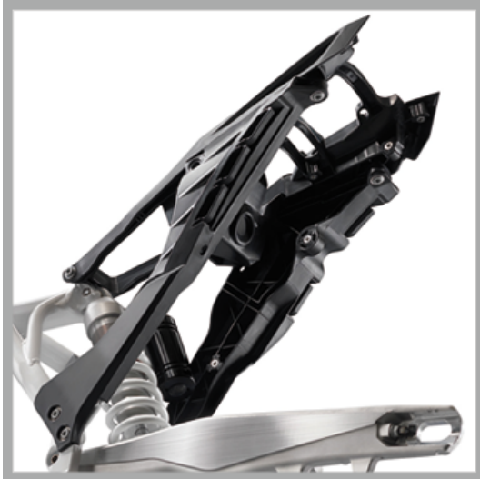
Figur 4: Termoplastramme i Husqvarna TE300 motorcrosssykkel. Plast har forbedret styrkeegenskapene så mye at termoplast nå benyttes som bærende konstruksjon i motorsykler. [101]
