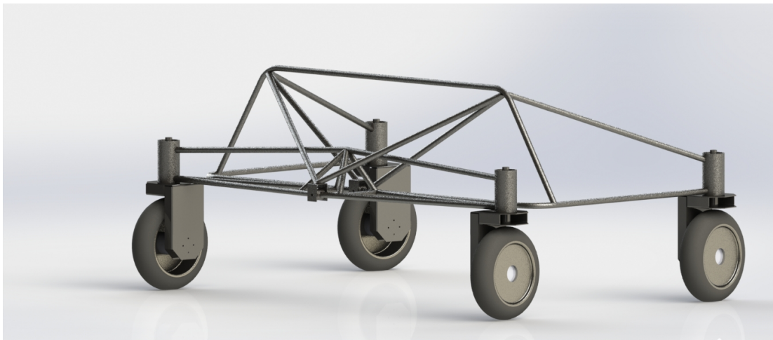
Figur 14: Forbedret rammekonstruksjon konstruert av stålrør.
