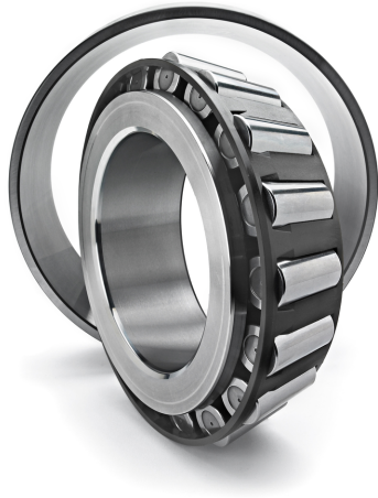
Figur 21: Konisk rullelager og oppsett av rullelager i par for å utjevne opptrædende aksialkrefter. [112][113]
