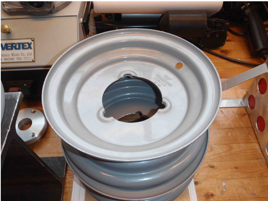
Figur 53: Senterhullet i felgen måtte utvides. Felgen på bildet mangler nye skruehull for skrueene som fester felgen til låseringen. Foto Fredrik Blomberg.
