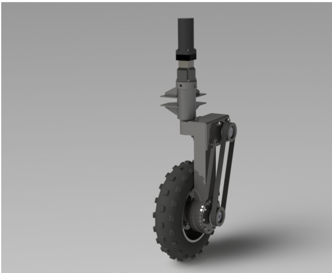
Figur 44: Sammenstilling av kulelagerhus og underarm.
