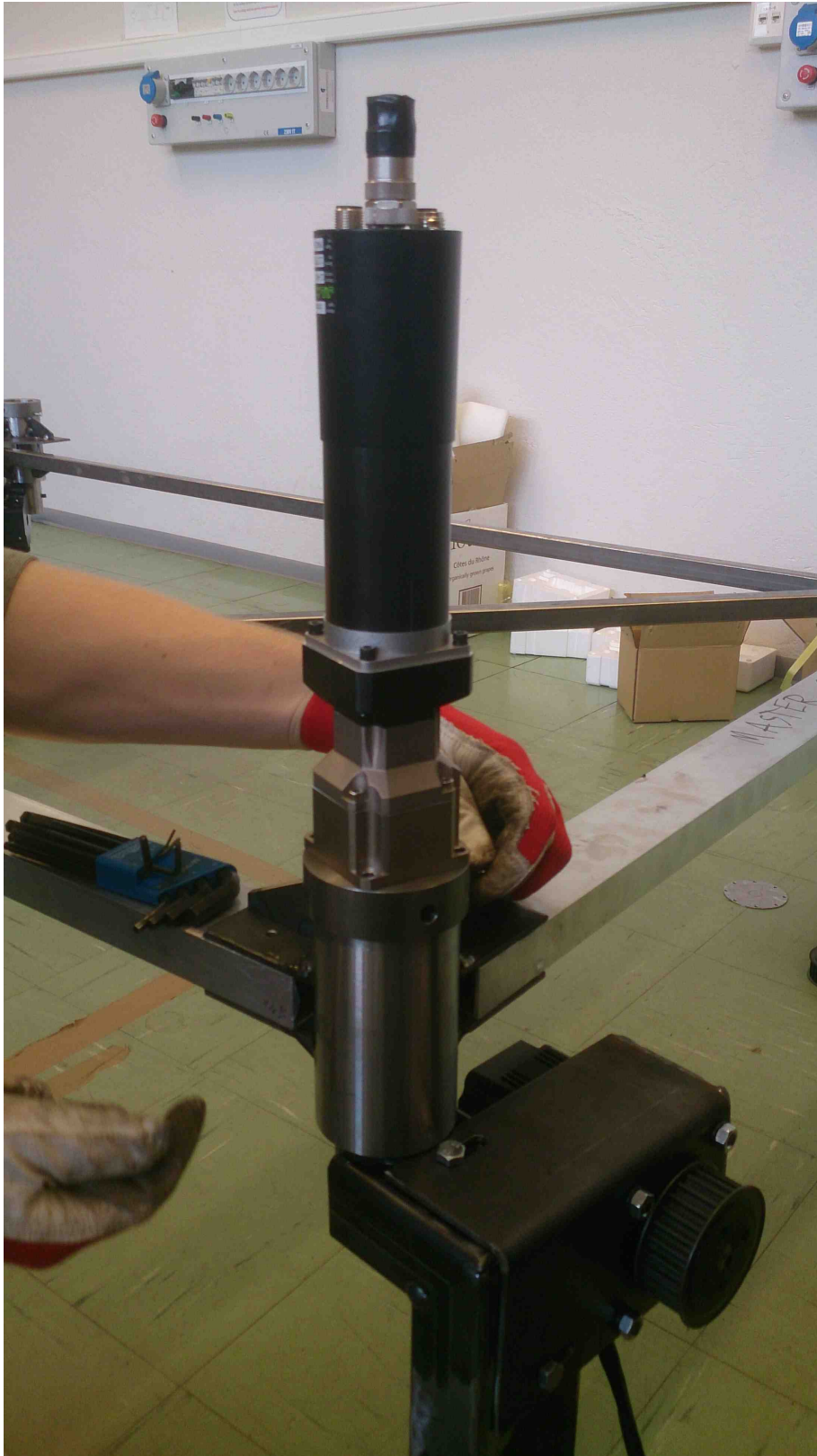
Figur 60: Montering av servomotor og gir. Foto Lars Grimstad.
