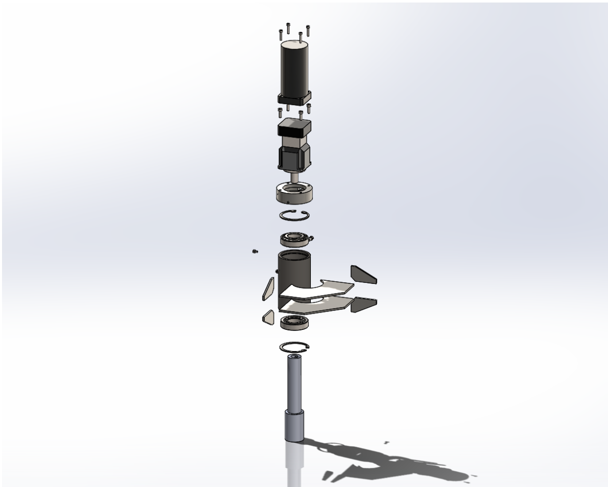
Figur 39: Eksplosjonstegning kulelager sammenstillingen.
