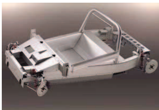
Figur 22: Chassiset til Lotus Elise, laget av ekstruderte og limte aluminiumprofiler[22].
