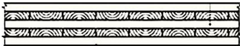
Figur 4: Massivtre element ( http://bks.byggforsk.no/News.aspx?sectionId=2&newsId=100 )
