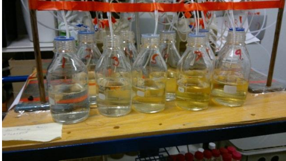
Figur 30: Tunnelvaskevannet etter filtrering. Det ble samlet opp 300 ml for vasking av prøvetakingssystemet. Foto: Jon-Henning Aasum
