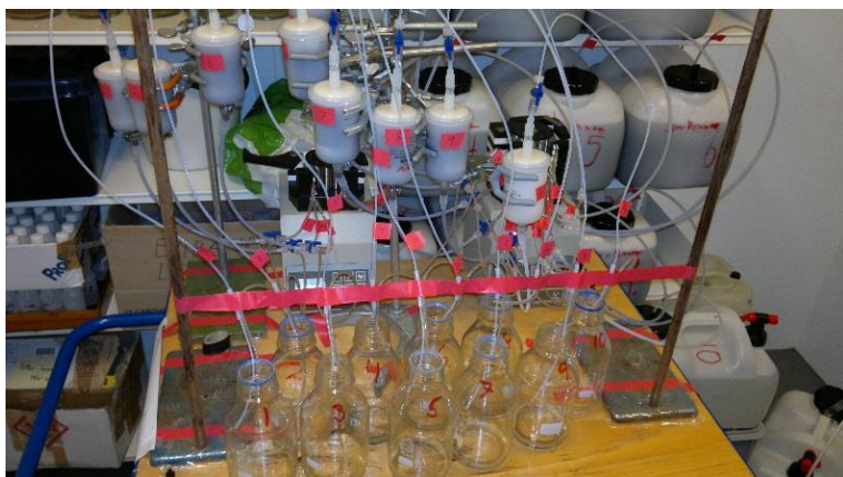
Figur 7: Oppsettet til prøvetakingssystemet. Vandunkene kan ses i bakgrunnen. Foto: Jon-Henning Aasum.
