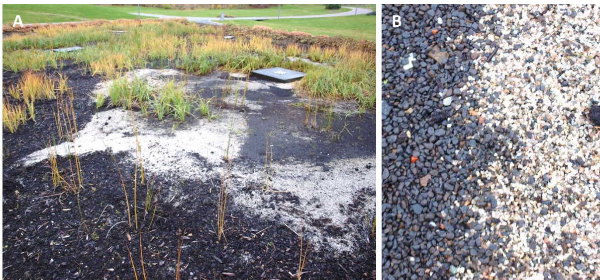
Bilde 18: Viser sortering av filterflaten til Biofilter 1 etter bytte av pumpe. Laget med Oslotorv hadde lagt seg som voller rundt nedslagsområdet til vannstrålen (A) og Filtralite hadde skilt seg fra filtersanden (B).
