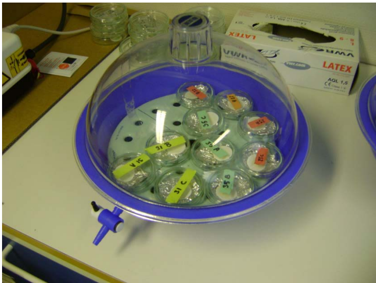
Figur 3.4: Her ligger filtrene i eksikatoren, i hver sine petriskåler, for å hindre at fuktighet fra luften absorberes og endrer vekten på filtrene, etter at de har blitt tørket i tørkeskapet. Filtrene ligger i hver sine merkede petriskåler for at en skal kunne skille de fra hverandre, for hvert filter har ulik vekt.
