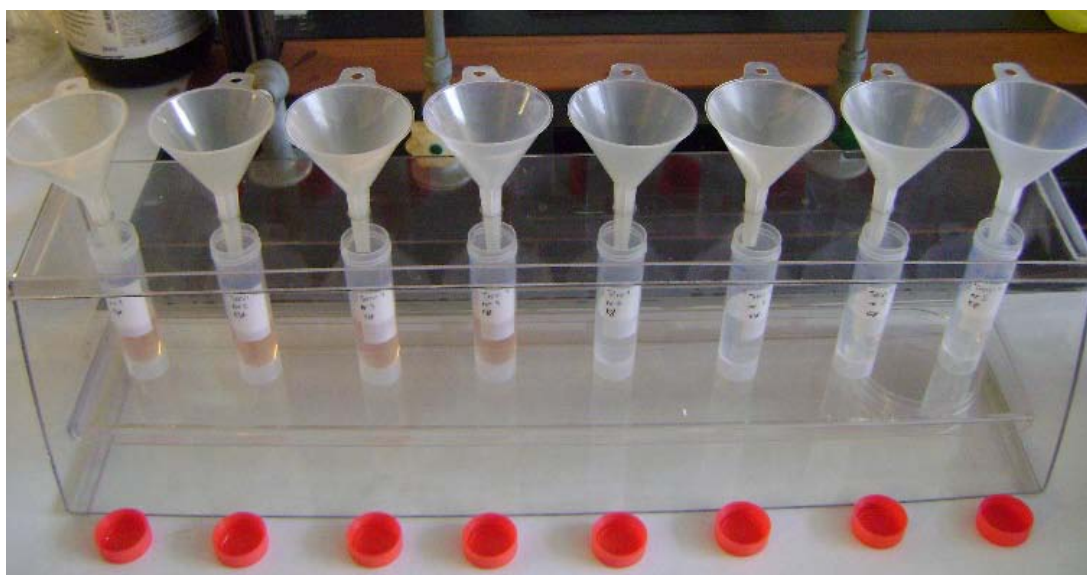
Figur 3.1: Figuren viser hvordan oppsettet for den sekvensielle ekstraksjonen så ut. For hver fraksjon ble supernatanten overført til plasttraktene, med filter i, og filtrert ned i hver sine sentrifugerør.
