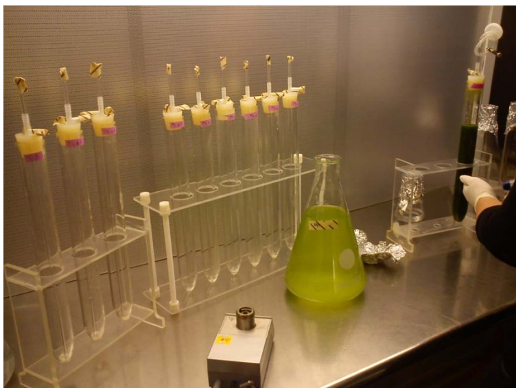
Figur 3.2: Bildet viser arbeidet i sterilbenken, hvor både algerør, gassbrenner, og erlenmeyerkolbe med alger og saltvann er vist fra forsøk 1. Algerørne vist i dette bildet er ferdigsammensatte, og autoklaverte, men de mangler slangen med filter på, samt slangeklemme. Dette ble satt på etter at løsningen var overført til rørene.
