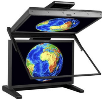
Figur 2.1: Planar SD2620W 26" Widescreen Stereo/3D Monitor. Skjermen består av en to monitører og en semirefektiv plate. Bilde fra den nedre skjermen skinner gjennom platen, mens bilde fra den øvre skjermen blir speilet i platen. De to bildene på platen vil gi en stereoeffekt ved hjelp av 3D-briller (bilde fra planar3d.com)
