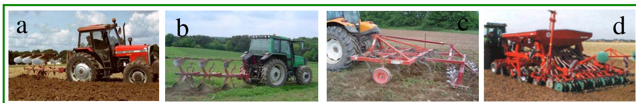
a : charrue 3 corps pour le labour classique ; b : charrue 3 corps pour le labour agronomique ; c : chisel pour le travail superficiel ; d : semoir spécifique utilisé initialement pour le semis direct
