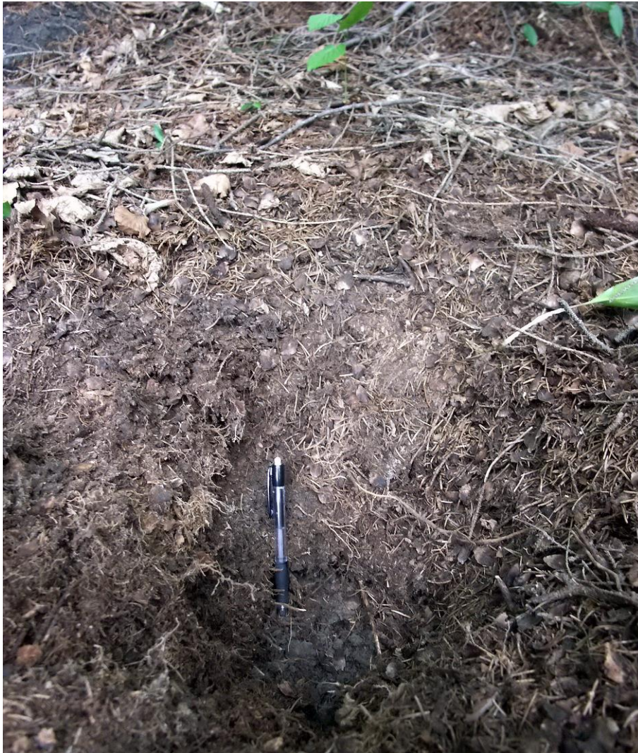
Figur 60: Graving 4, under gran. Mineraljorden starter ved den sorte gummien på pennen. Skille mellom mineraljord og strølag var markant.
