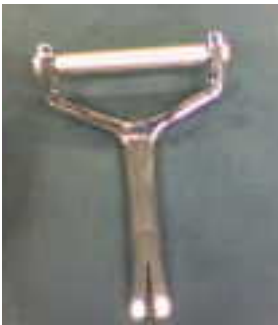
Figur 4. Bilde av rulle brukt til knusing og homogenisering av sediment. (Foto: Malin Torp).
