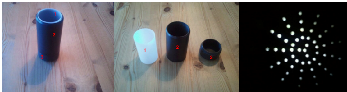
Figur 3. Bildeserie som viser sentrifugerør brukt til å sentrifugere ut porevann fra sedimentprøver. Første bilde til venstre viser røret sammensatt med nummerering fra 1-3 på ulike deler. Bildet i midten viser alle delene hver for seg. Bildet til høyre viser den perforerte platen (merket 3) som befinner seg nederst i røret merket med tallet 2. (Foto: Malin Torp).
