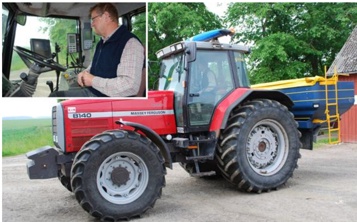
Bilde 2: Bildet viser traktoren, N-sensoryret og gjødselsprederen til en av brukerundersøkelsens deltagere. N-sensoren (tradisjonell utgave) er montert på hyttetak. I innfelt bilde vises sensorens Windowsbaserte styringsterminal lengst til venstre og gjødselsprederens terminal i midten. (Foto: Hans Håkon Helmen)
