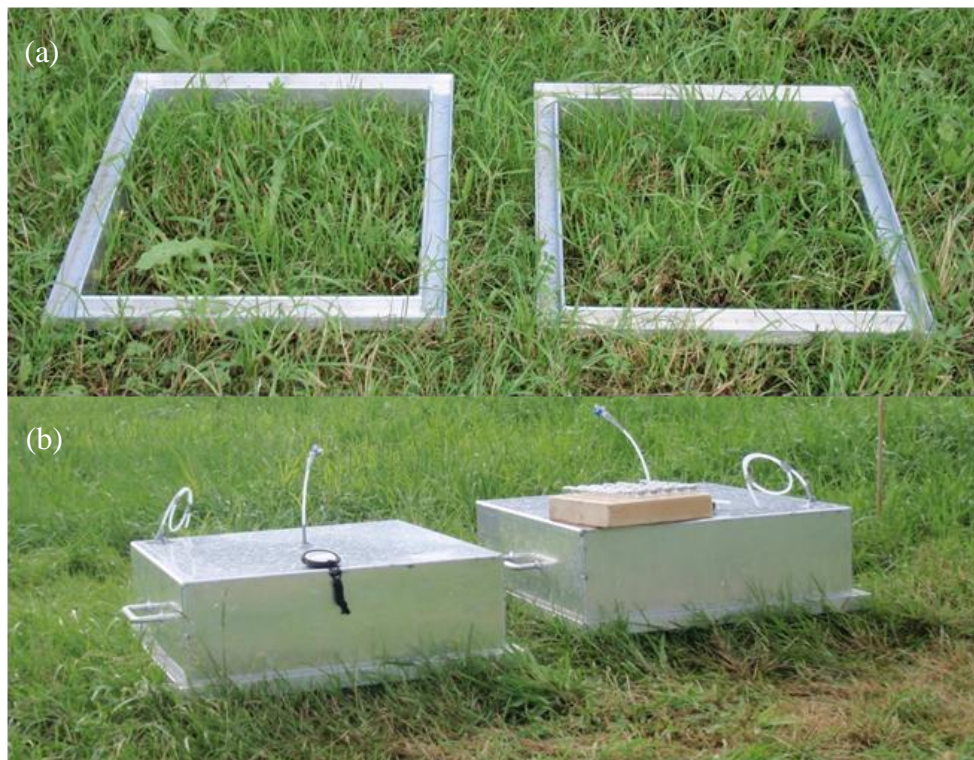
Figur 4. Oppsett av statisk kammermetode med a) permanente rammer med kanal for vatn og b) kammer plassert over rammer ved måling av N_2O – emisjon.
