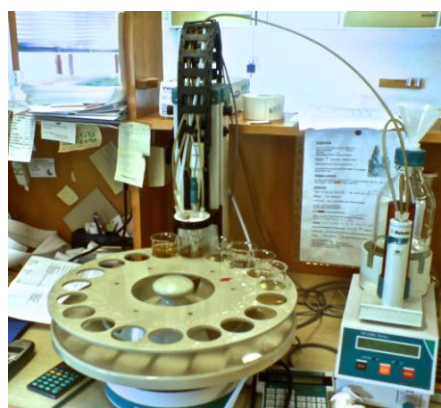
Bilde 30: Den fullautomatiserte titratoren som ble brukt til måling av titrerbar syre
