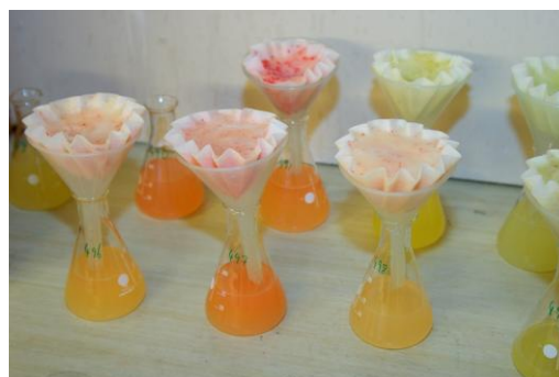
Bilde 32: Første filtrasjon av eplesaften under opparbeiding for HPLC-analyse
