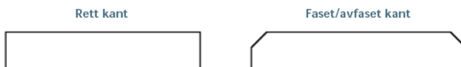
Figur 2 viser forskjellen på rett og faset/avfaset kant. Figurene er hentet fra bufetat sine hjemmesider.
