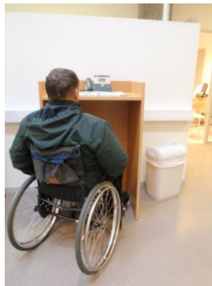
Figur 40; telefon for brukerne er plassert på ujusterbart bord.
