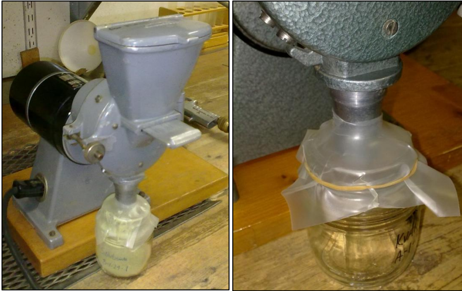
Figur 3.3.2 Oppsett av plantekvern. Tørre plantedeler legges i trakten på toppen og kommer ferdig malt ut i glasset som har parafilm over deler av åpningen.
