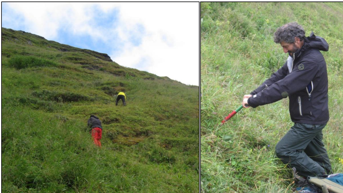
Figur 3.2.1 Til venstre: Innsamling av vegetasjonsprøver i bratt skråning. Til høyre: Jordprøvetaking ved hjelp av sylindrisk jordbor.
