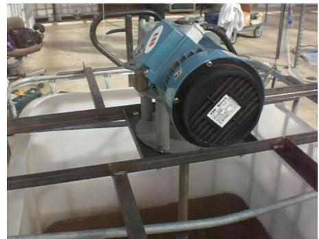
Figur 3-7. Stativet til røreverket var tilpassa buret kring tanken.
