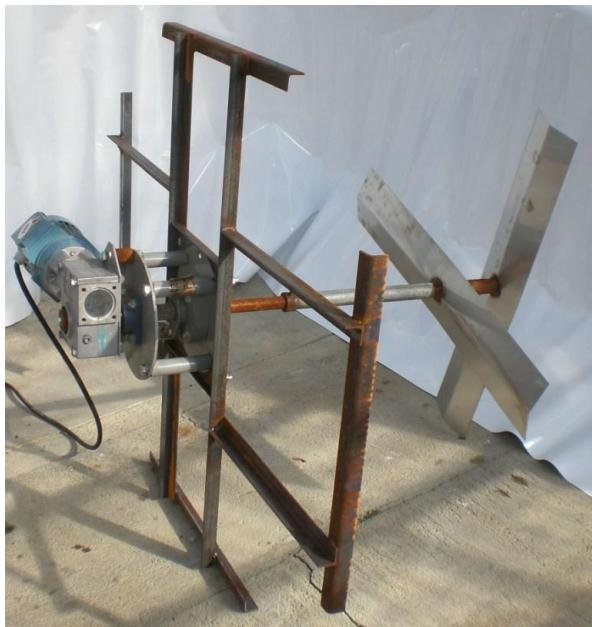
Figur 3-6. Spesiallagt røreverk. Blad i rustfritt stål som var festa til ein motor.
