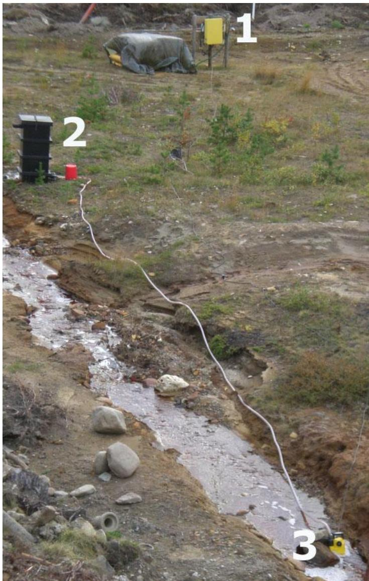
Figur 3-10. Oppsett prøvetaking i Folldal. 1) Straumskap, 2) filterbrønnen og 3) pumpa.
