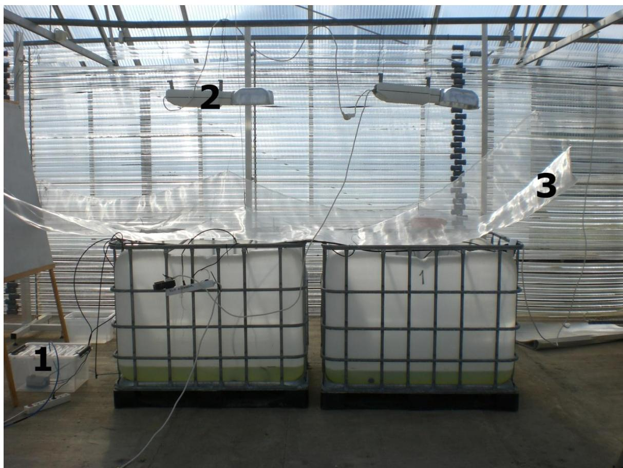
Figur 3-2. Algedyrking i siste fase. To opne tankar (1000 L) vart brukt for å auke volumet til 340 L totalt. Det vart brukt 1) tilføring av CO<sub>2</sub> (sjå òg Figur 3-1), 2) kontinuerlig lysekspонering og 3) flugenetting.
