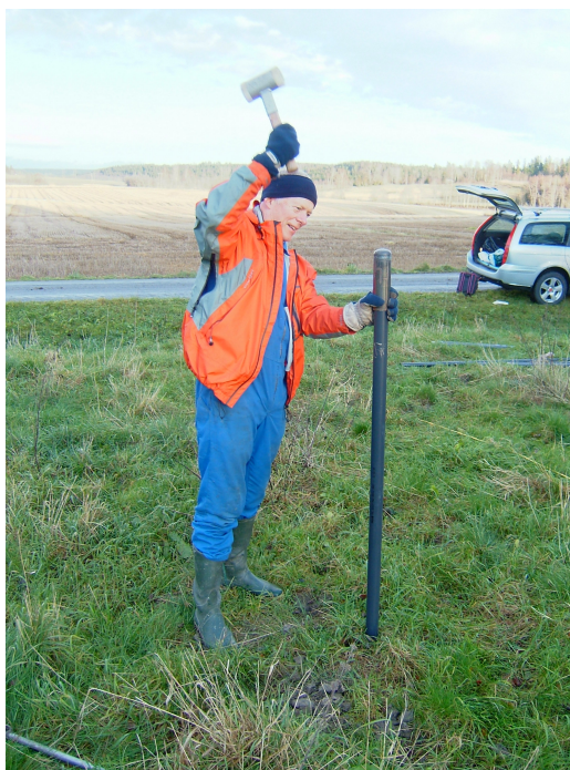
Bilde 1: Nedslåing av søyler i felt (Krogstad 2008).
