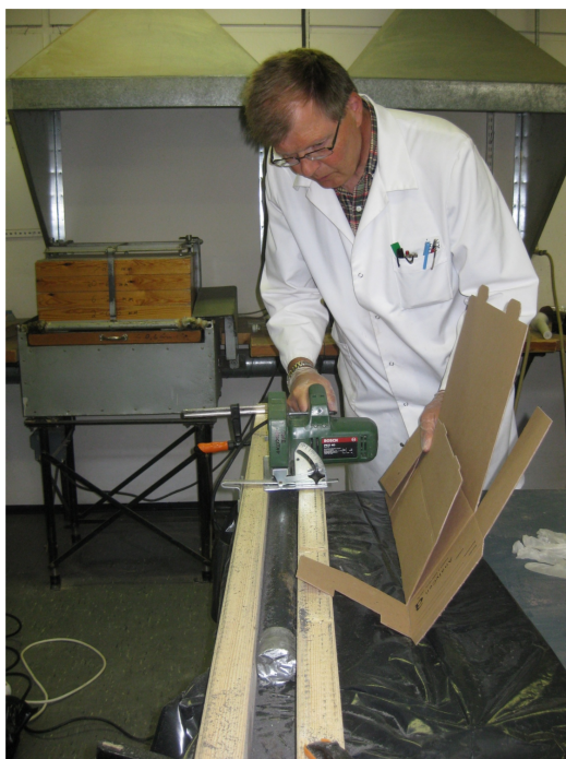
Bilde 2: Plastsøylene ble åpnet med en sirkelsag mens de var frosne.
