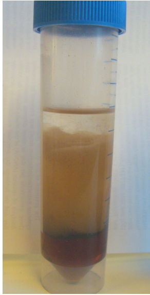
Figur 5.1: Emulsjon dannet ved ekstraksjon av MeHg med toluen i SRM DOLT-4 (fiskelever).
