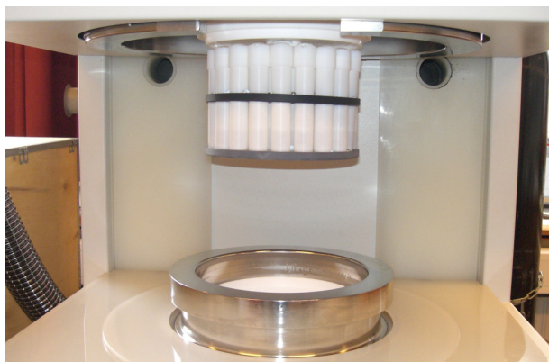
Figur 2.6: Oppslutning i UltraClave. Teflonrørene inneholdende prøvene er plassert i posisjonskarusell. Denne senkes så ned i load, et vannbad bestående av 320 ml vann, 2-3 ml H_2SO_4 og 20-30 ml H_2O_2 , som varmes opp ved hjelp av mikrobølger.
