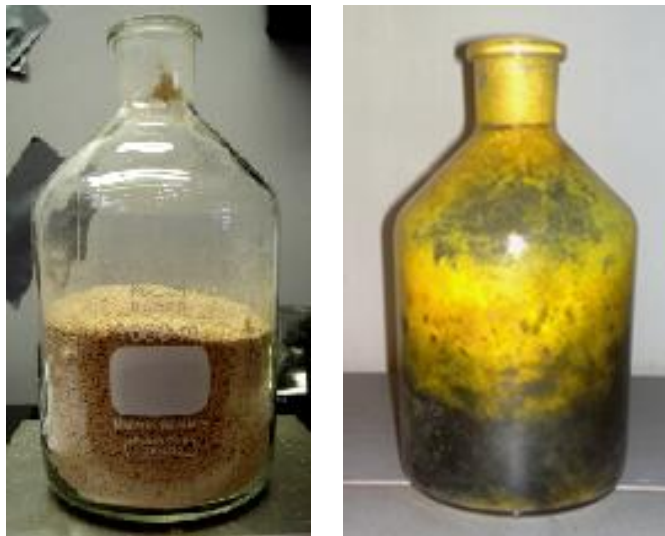
Figur 5: Bilder av flaske med innhold, før og etter pyrolyse. (Foto: Rød, 2009)
