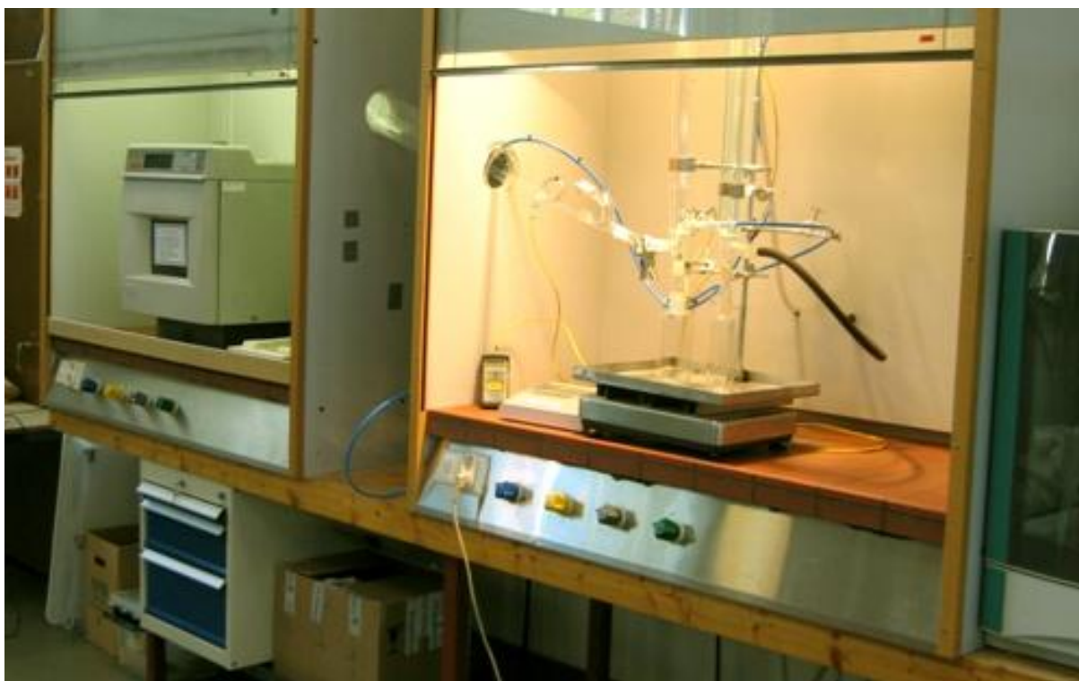
Figur 1: Mikrobølgepyrolyseanlegget som var brukt under forsøkene. I avtrekkskap til venstre er selve mikrobølgeovnen, i skapet til høyre er destillasjonskolonnene. (Foto: Geoffrey Gilpin)
