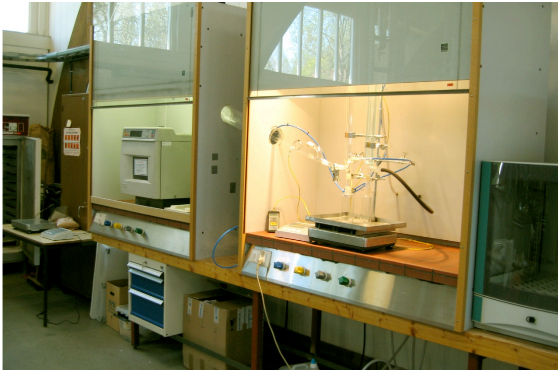
Figur 2.5 Bilde over mikrobølgepyrolyseanlegget som ble brukt under forsøket (Rindal et al. 2007).
