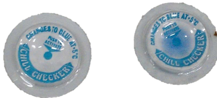
Figur 4: Temperaturindikatorer av typen "Chill Checker". Indikatoren til venstre viser opprettholdt kjølekjede, mens indikatoren til høyre viser brutt kjølekjede.
