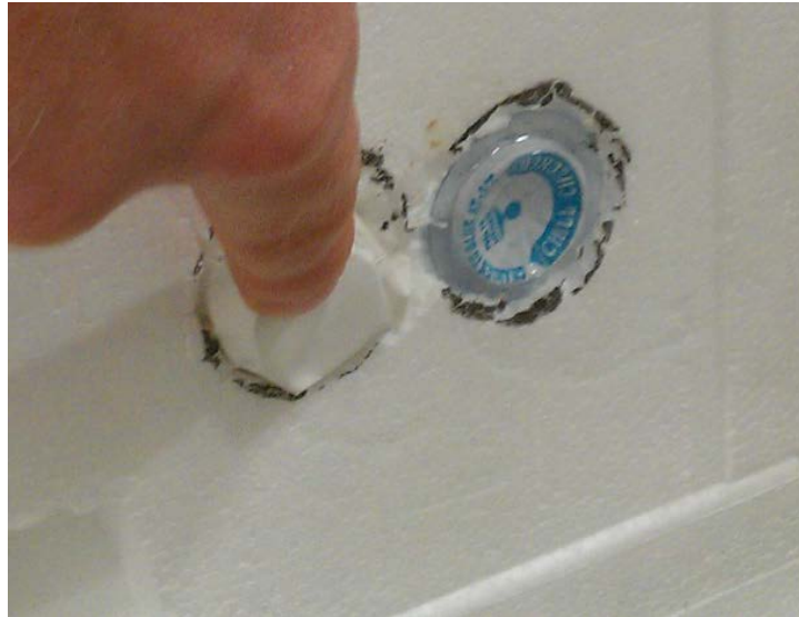
Figur 5: Festing av merket temperaturlogger til venstre og temperaturindikator til høyre.
