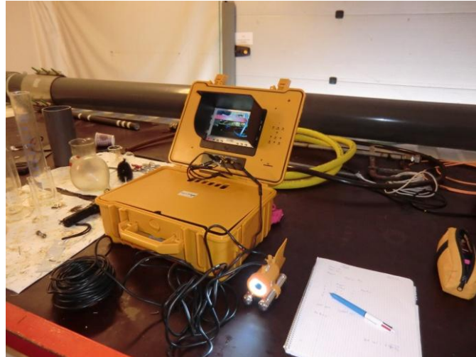
Figur 6-11: viser videoutstyr med monitor, kamera og opptakstutstyr, klar til bruk
