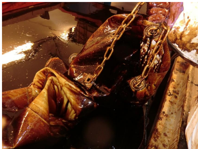
Figur 6-15: viser testbasseng og utstyr tilgriset med olje, etter test, under demontering
