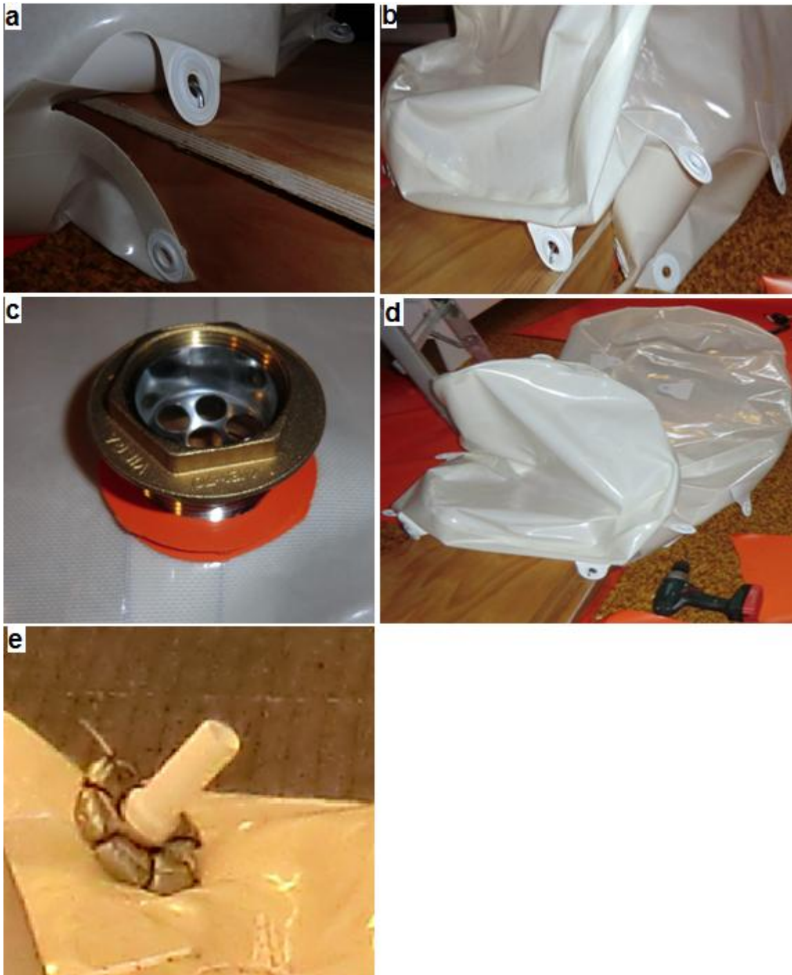
Figur 6-3: a-b) viser festepunkter på Oppsamler c) viser gjennomføring og kobling til pumpetårn, før montering d) viser oppsamler lagt ut med festepunkter d) viser pumpetårn med flyteelement og koblingsrør ferdig montert på Oppsamler
