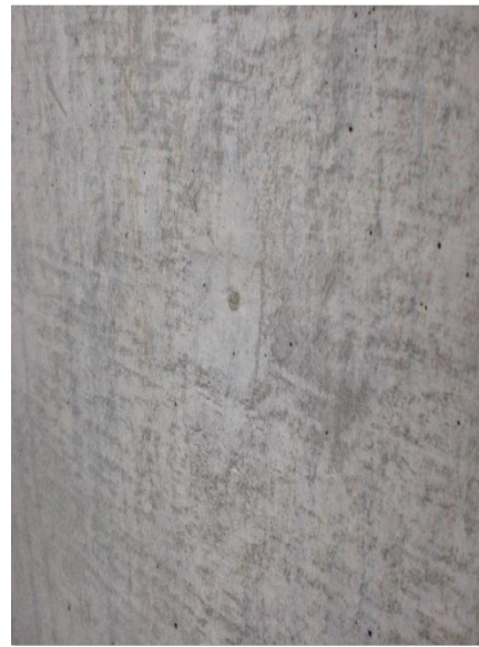
Figur B.2: Overflate - lavkarbonbetong [1]
