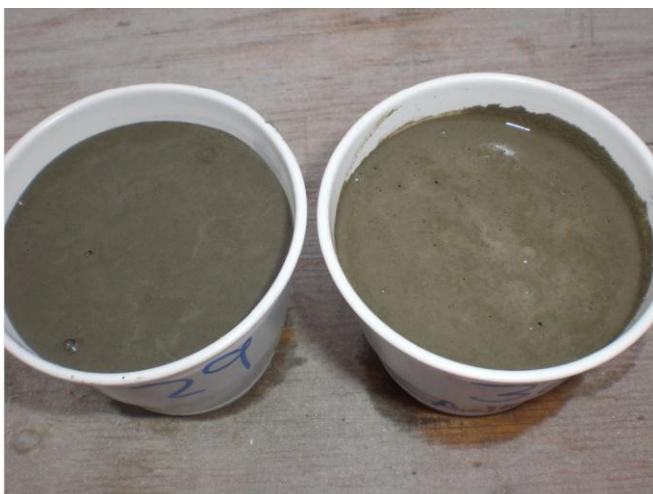
Figur 5.2: Finstoff - Lavkarbonbetong og referansebetong [1]
