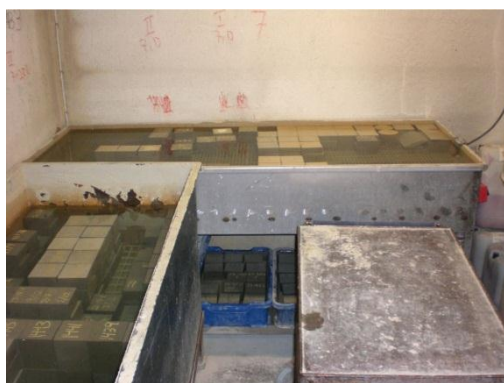
Figur A.6: Plassering av prøvelegemene i vannbad hos Unicon [1]
