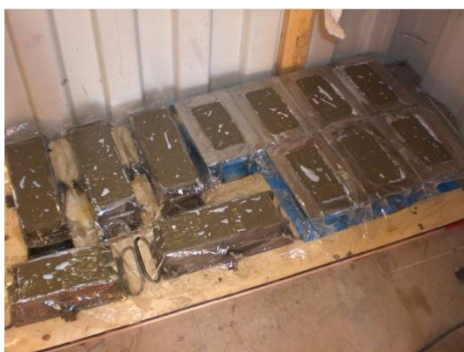
Figur A.3: Fersk betong til herding i container [1]
