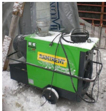
Figur 5.5: Gass-aggregat til oppvarming [1]
