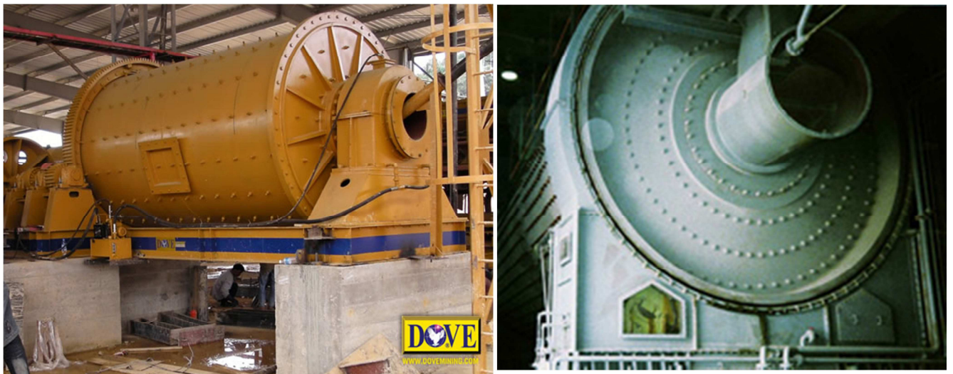
Figur 13.(a) Mølle opplagret i tapp (DoveMining), (b)Opplagret i skall, (KHD)
