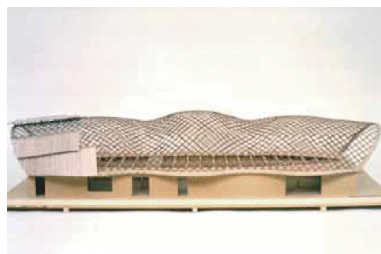
Figur 5.19: Skalamodell av bærekonstruksjonen (Foto:Buro Happold/Mandy Reynolds)
