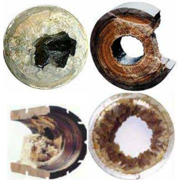
Figur 7: Asfaltene aggregerer og utfelles når trykk eller temperaturen endrer seg [6].
