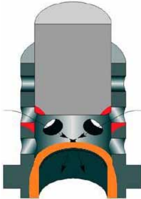
Figur 26: Strømningsprinsipp for FMC sin bur choker når choken delvis er lukket. Væsken strømmer inn gjennom ulike hull i buret og krasjer i midten. Denne krasjen fører til hastighetsreduksjon. Det røde område er det område choken først blir slitt og der etter det gule området [11].
