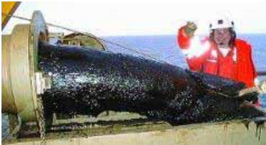
Figur 5: Voks oppstår når produksjonsrør med hydrokarbon utsettes for lav temperatur [6].
