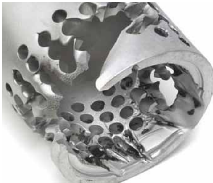
Figur 12: Del av et bur til en plugg og bur choke som er utsatt for erosjon [11]. Mer informasjon om erosjon kommer seinere i oppgaven.
