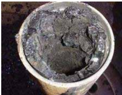
Figur 7: Asfaltene aggregerer og utfelles når trykk eller temperaturen endrer seg [6].
