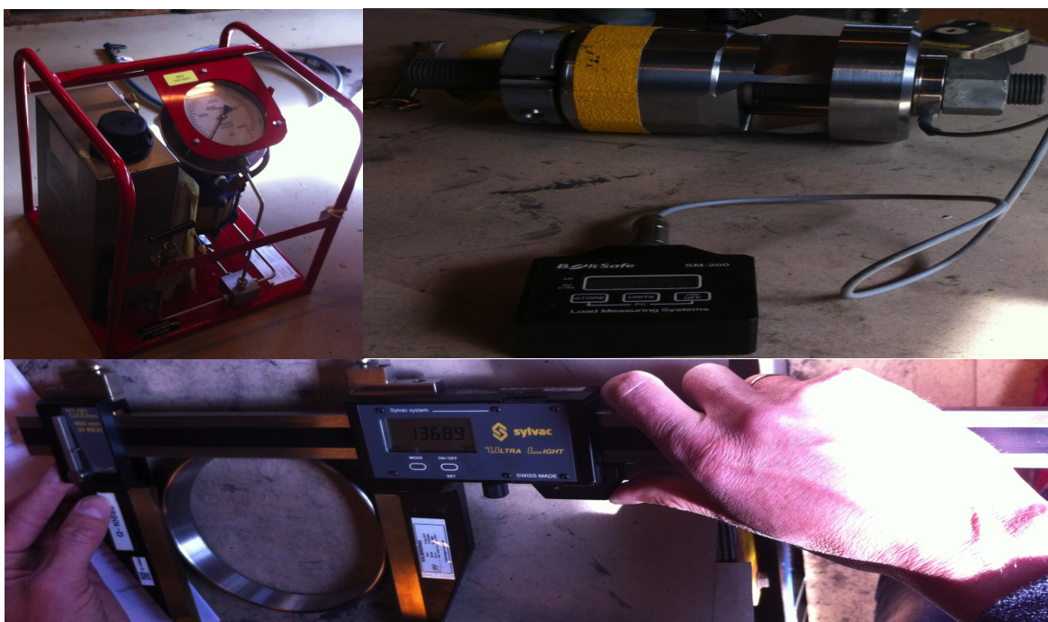
Figur 50: Øverst til venstre: Den hydrauliske pumpen, Øverst til høyre: Test av veiecelle, Nederst: Skyvelære.
