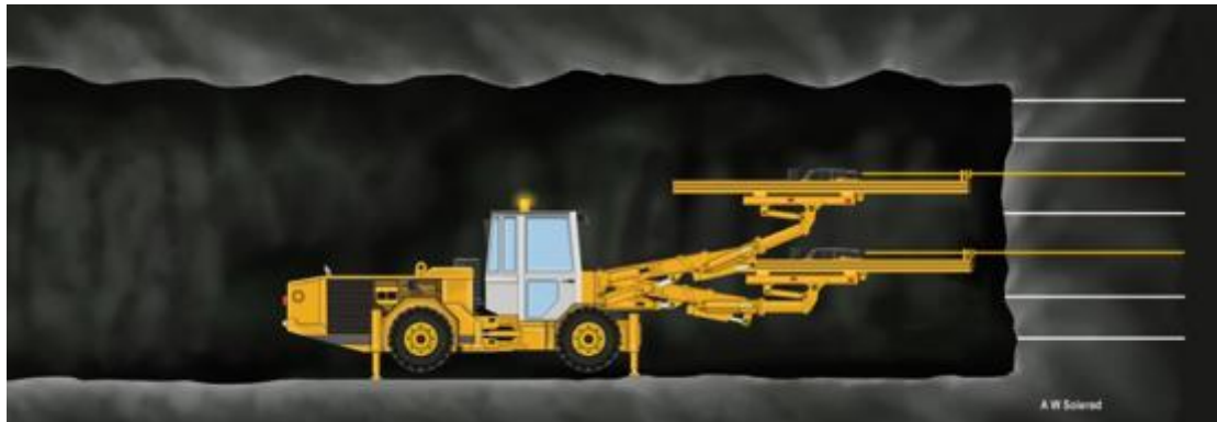
Figur 6. Salveboring med borerigg.[24]
