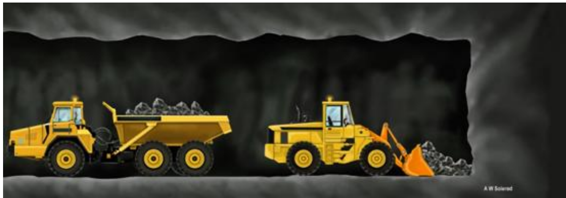
Figur 9. Lasting og transport med hjullaster og dumper.[24]
