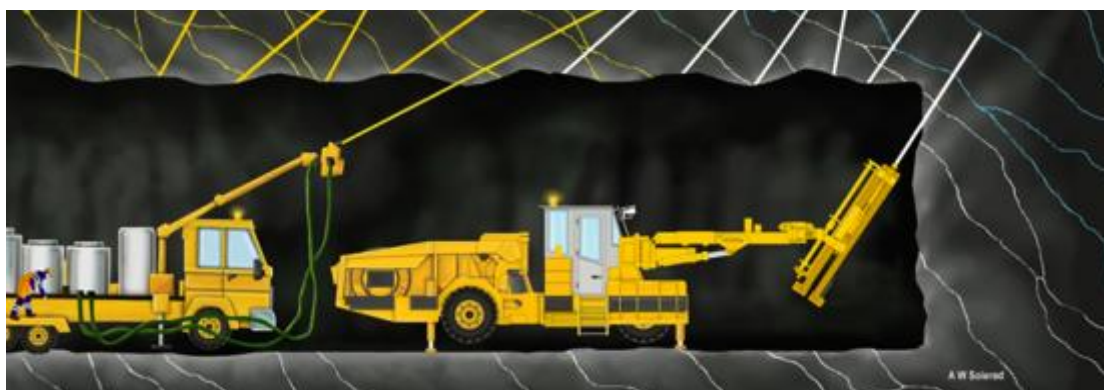
Figur 5. Injeksjonsboring og injeksjon av betong.[24]
