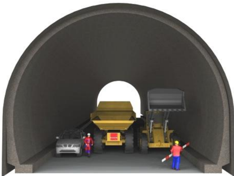
Figur 15. Tverrsnitt av Ulvintunnelen.[18]
