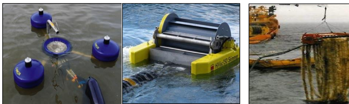
Figur 7: venstre ) overløpsskimmer (Lamor 2013), midt ) Hi-Wax skimmer (Knudsen 2009), høyre ) Foxtail skimmer (Eureka 2013)
