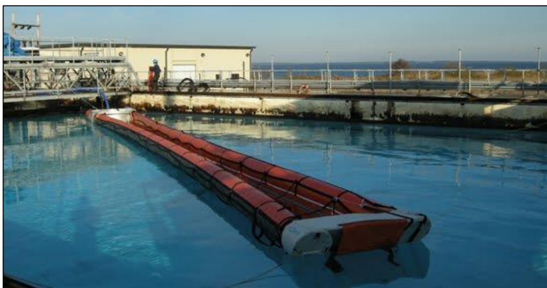
Figur 8: Oljevern prosjektet Oilshaver ved testing i USA (OilShaver 2010)
