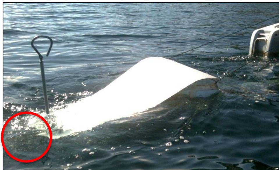
Figur 75: Slusen i fart sett fra siden. Rød sirkel viser hvor oljen steg opp (foto: eget)
