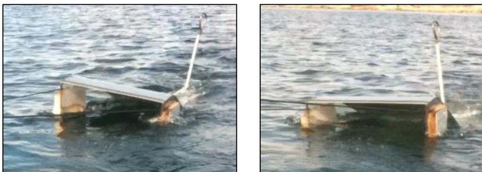
Figur 72: Sluse i sjø med 3 kg vekt (foto: eget)
