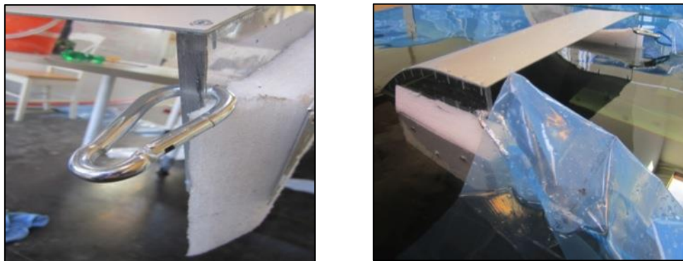
Figur 56: Venstre ) Karabinkor kvestet til innløpsvegg, høyre ) linsen festet helt opp i innløpsvegg (foto: eget)
