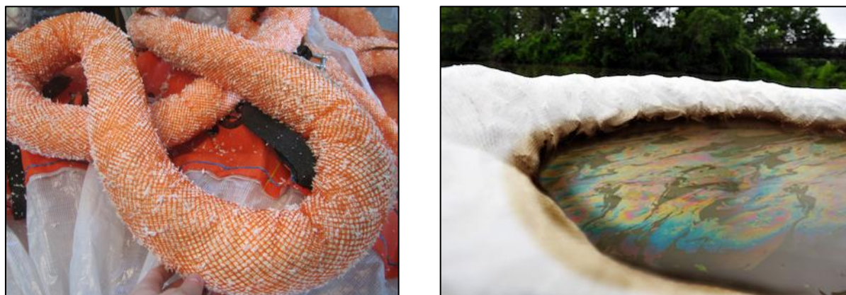
Figur 5: venstre ) viser innmaten på en sorbent lense brukt av kystverket. Høyre ) En sorbent-lense som ligger i olje (Corp 2008).
