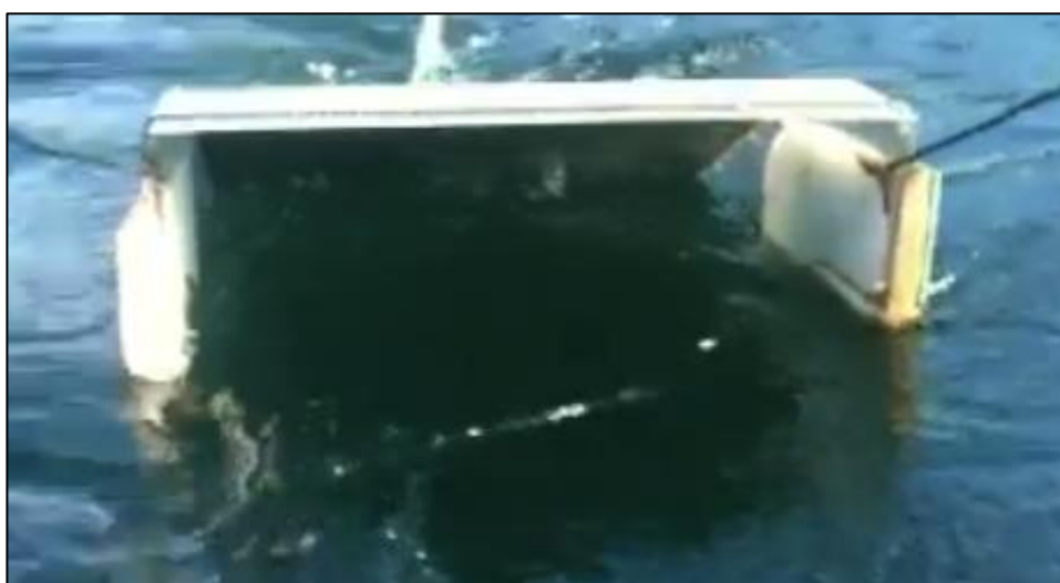
Figur 74: Første forsøk med olje i vannet. Bilde viser innløpet på slusen (foto: eget)
