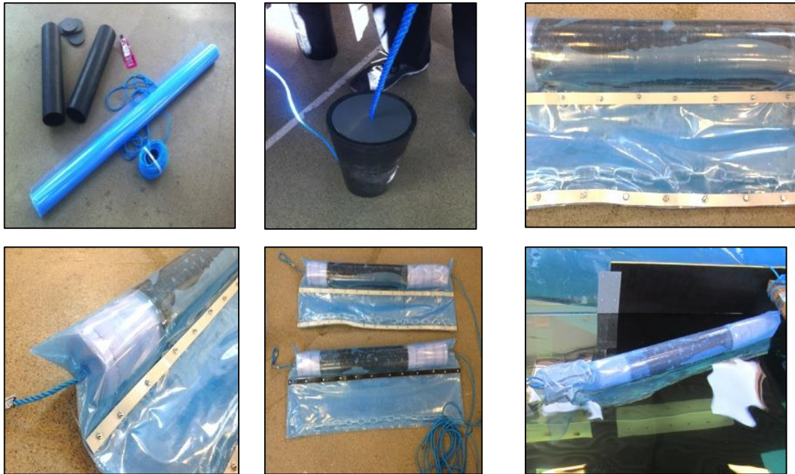
Figur 47: Konstruksjon av lensene: øverst venstre ) materialet brukt, øverst midt ) tau festet til enden på rør, øverst høyre ) rør dekket med plast, nederst venstre ) innsydd isoporbiter, nederst midt ) to ferdige lenser, nederst høyre ) linse i vannet (foto: eget)
