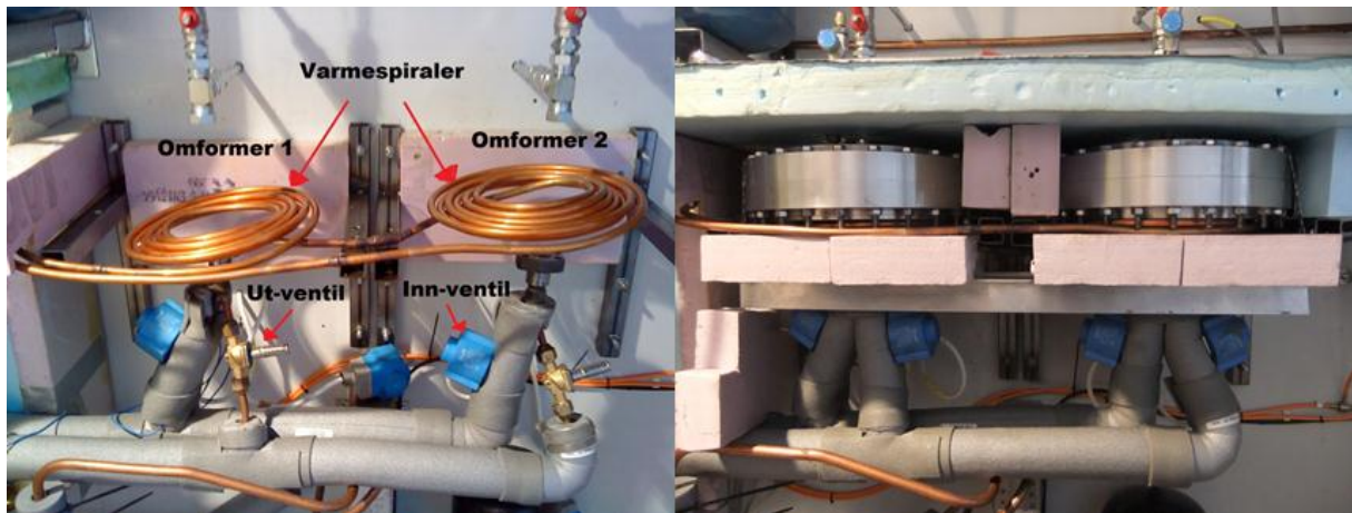
Figur 3.4 Til venstre vises varmespiralene og ventilene til omformerne. Til høyre er omformerne og isolasjonen rundt på plass.
