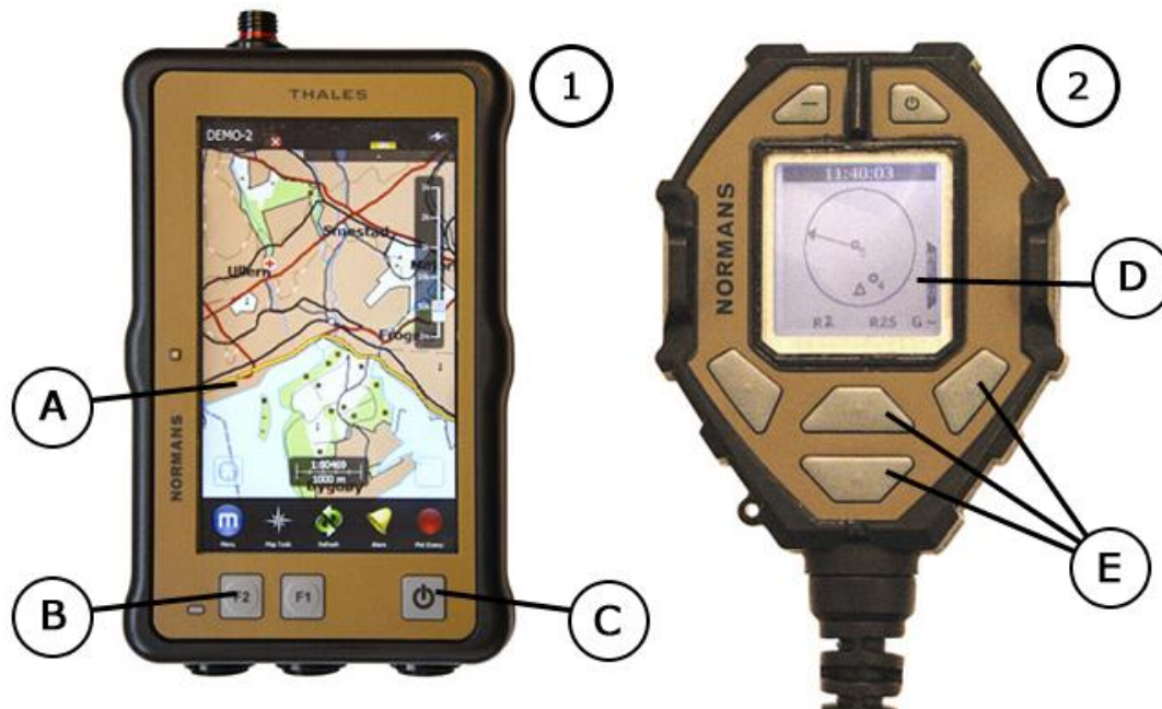
Figur 11: Prototyper av NORMANS KKI ledelse (1) og lett (2), vist under Defence & Security Equipment International (DSEi) i London 2011. NORMANS KKI ledelse består av en berøringsskjerm (A), modusknapper (B) og en av/på knapp (C) og er brystmontert. NORMANS KKI lett har et enklere grensesnitt, med svart-hvitt skjerm (D) og betjeningsknapper (E) og festes på håndleddet. 5
