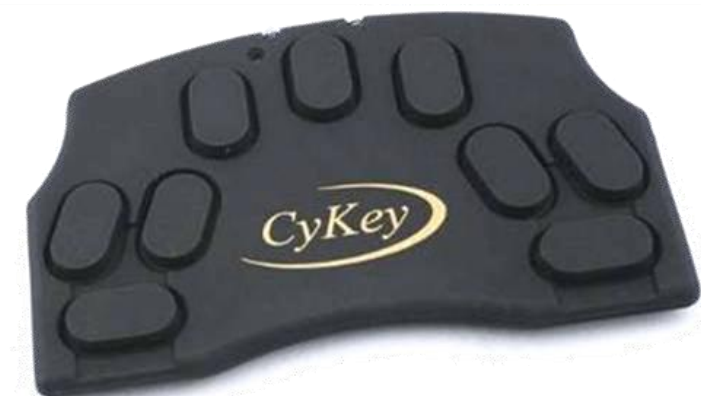
Figur 9: CyKey består kun av en plate med ni knapper. Disse trykkes ned i formen til bokstaven man ønsker å skrive. 29
