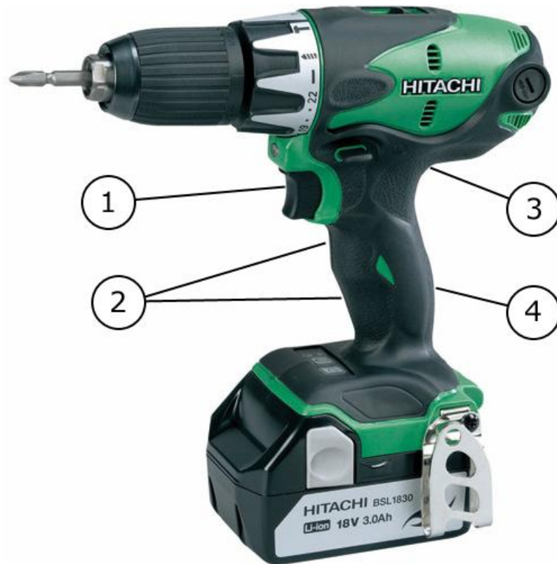
Figur 52: Hitachi batteridrill. Grepet er utformet for å ta høyde for de to forskjellige knekkvinklene (2) mellom leddet til lillefinger-ringfinger og pekefinger-langfinger. Drillen har uthevet avtrekker (1), en flate for å bære vekten til drillen (3) og en buet form for å passe inn i hånden (4). 34
