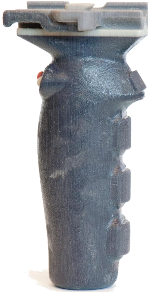
Figur 71: Bildet viser 3D modell av vertikalgrepsformet tastatur for testing av ergonomi. Foto: Henrik Homberg
