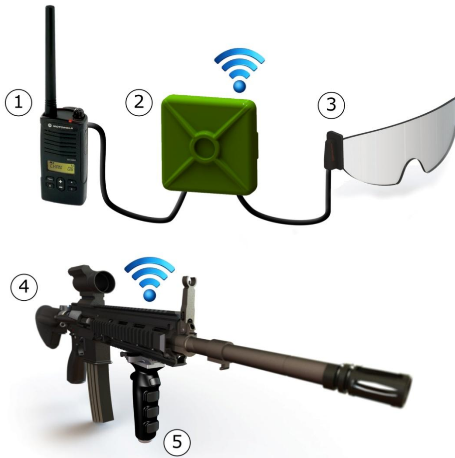
Figur 78: Det totale kommunikasjonssystemets oppbygging, bestående av ekstern radio (1), datamodul (2), skjermbrille (3) og tastatur (5) med blåtann på våpenet (5).
