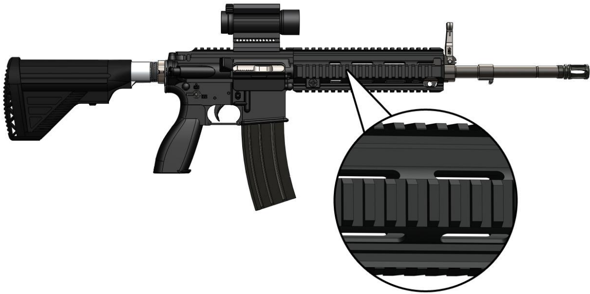
Figur 16: 3D-tegning av HK416, vist med NAR systemet. Detaljvinduet viser skinnene med riller integrert i forkjefftet.
