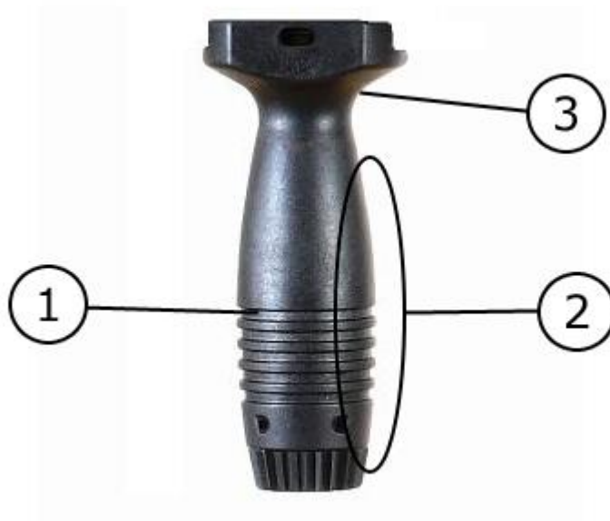
Figur 51: Vertikalgrep fra Heckler & Koch. Formen er rotasjonssymmetrisk og er tykkere på midten (2) for at hånden ikke skal gli av. Det er lagt inn riller i bunnen som kan gi høyere friksjon (1) og potensielt lede vekk svette fra hånden under bruk. Toppen gir en flate som kan ligge an mot oversiden av hånden for å bære vekten til våpenet (3).
