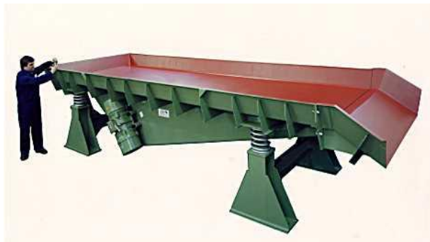
Figur 35[19] Vibrotransportør som transporterer flis ved hjelp av vibrasjon.
