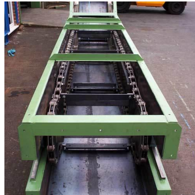
Figur 34 [18] Skrapetransportør som skaper flisen framover ved hjelp av profilene som sitter på kjedet.
