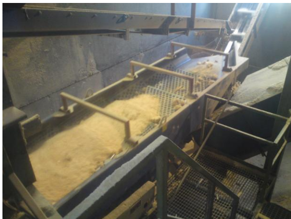
Figur 8 Dagens grovsold, ei vibrorenne med ei soldingsplate.
