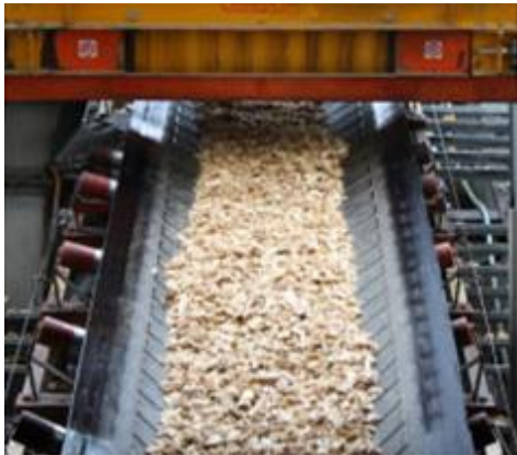
Figur 33 [17] Båndtransportør med medbringerbånd som transporterer sagflis.
