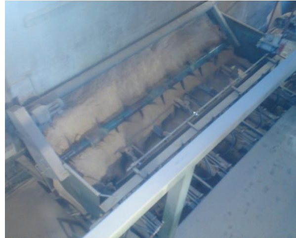
Figur 7 Innmating av sagflis med stangmater.
