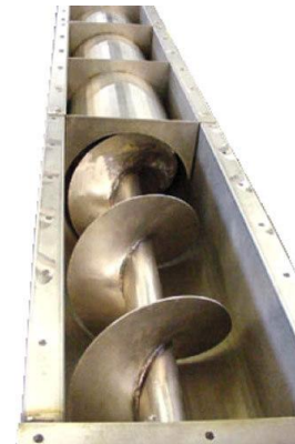
Figur 36 [20] Skruetransportør som driver flisen fremover ved at skruen roterer.
