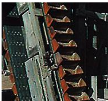
Figur 37 [21] Elevator løfter materialer som skal opp i høyden. Den har skuffer som graver til seg materiale.
