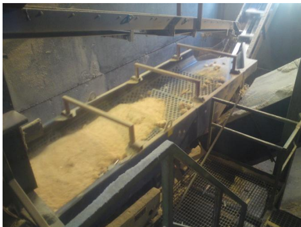
Figur 17 Grovsolding i dagens anlegg er laget sammen med ei vibrorenne som stangmateren fyller med sagflis.
