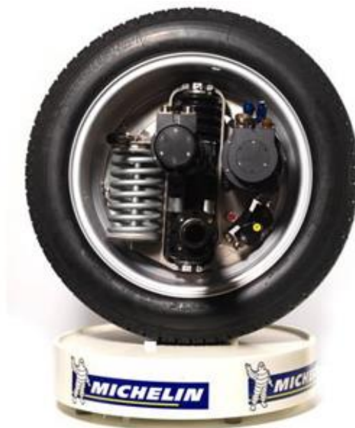
Figur 7.23: Dekkprodusenten Michelins modell av et direkte driftshjul. Viser også at praktisk gjennomføring kan være av stor kompleksitet [84].
