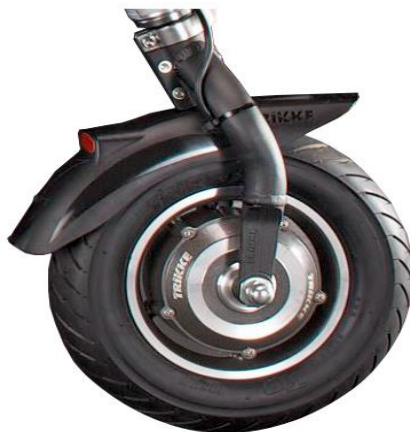
Figur 7.25: Et enkelt hjuloppheng for navmotor sentrert på forhjulet. Forgaffelen monteres direkte til motoren [86].
