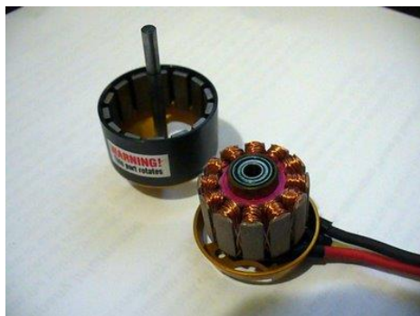
Figur 7.45: Innmaten i en børsteløs motor viser en kompakt utforming [112].
