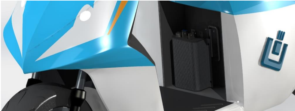
Figur 10.17: Batteri- og controllerplassering.
