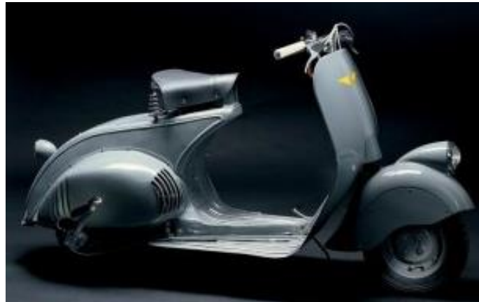
Figur 9.8: Vespas Piaggio MP5, en av de første scootere med selv bærende konstruksjon [142].
