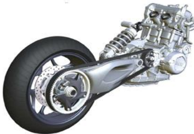
Figur 7.19: Oppsett for tannreim må gjøres med grundighet da den ikke må komme i kontakt med hindringer under drift. Illustrasjon utviklet av BMW [75].
