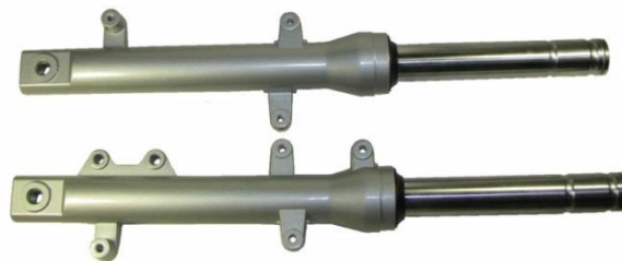
Figur 7.48: Deler av fronthjulsopphenget som drives på hydraulisk prinsipp [131].
