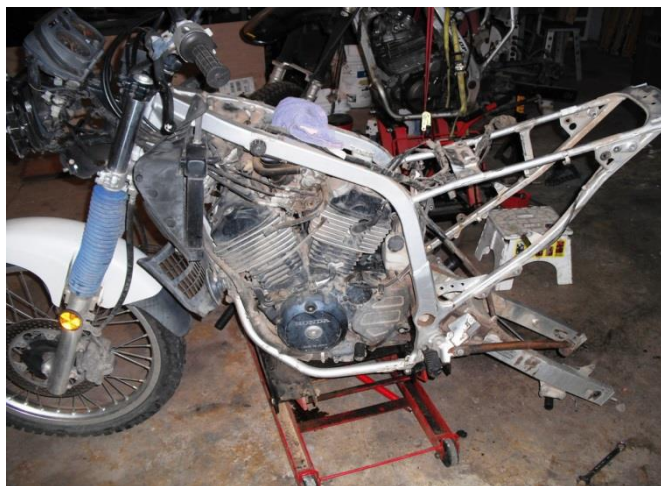
Figur 9.5: Illustrasjon av en dobbel backbone rammeløsning [139].
