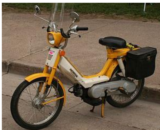
Figur 9.6: Moped med åpen rammeløsning [140].
