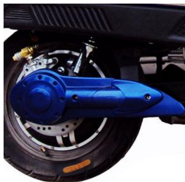
Figur 7.27: Eksempel på navmotor sentrert på bakhjulet, svingarmen er en del av innfestningen av motoren [87].
