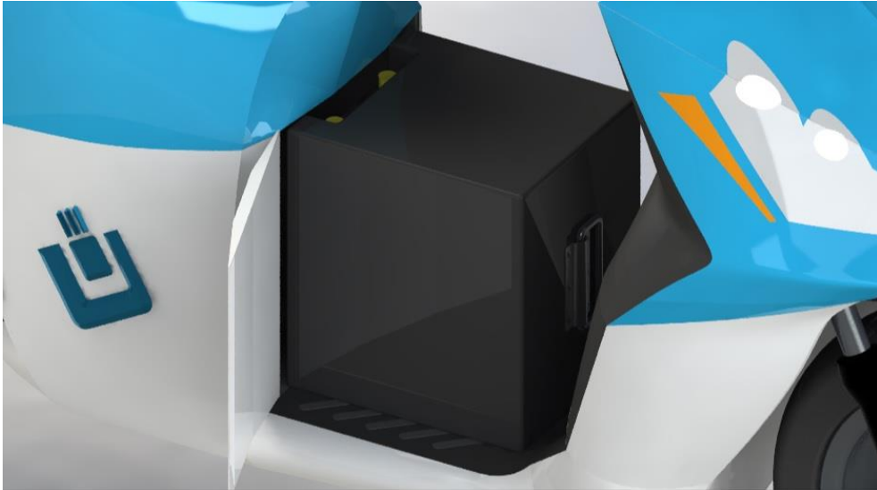
Figur 10.16: Utskiftning av batteri 2.
