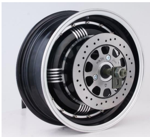
Figur 7.46: Hubmotor, modellnr.: QS7230-13403 [112].
