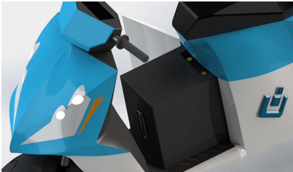
Figur 10.15: Utskiftning av batteri 1.
