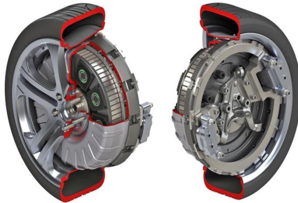
Figur 7.22: Navmotor slik den er presentert av Protean Electric, motoren ligger innkapslet i felgen [82].
