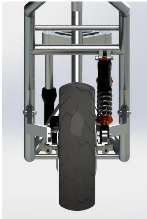
Figur 9.18: Løsningsillustrasjon for hele bakhjulsopphenget, og kobling mot rammen.
