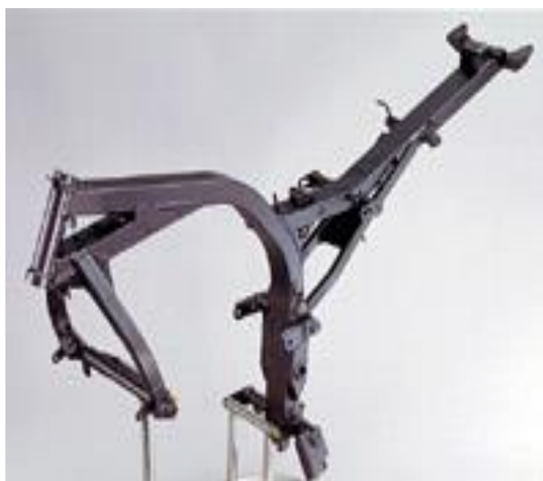
Figur 9.4: Singel backbone rammeløsning [138].
