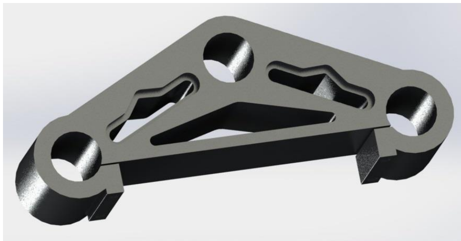
Figur 9.23: Illustrasjon av styrebro.
