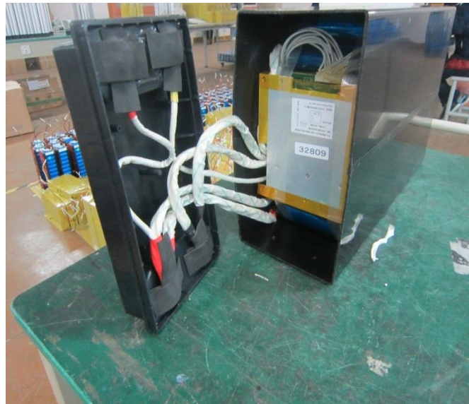
Figur 7.11: Et eksempelfoto produsert av leverandør, Headway, på hvordan ønsket batteripakke vil se ut.
