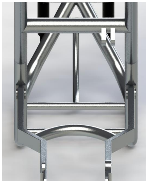
Figur 9.22: Svingarm – kobling mot rammen.
