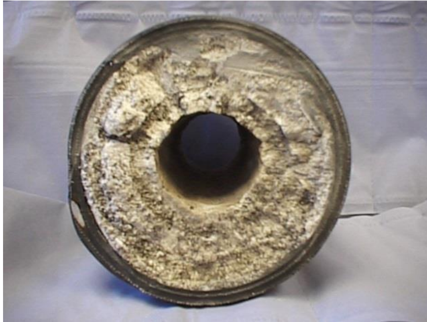
Figur 8. 150mm diameter rør redusert til 60mm etter 12 uker med struvitt felling.
