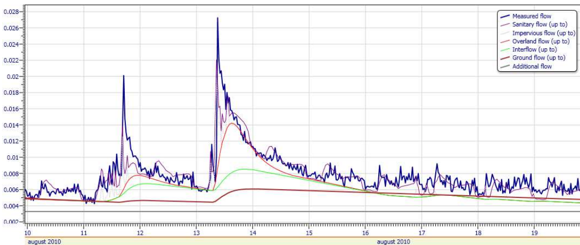
Figur 14. Regnvann hiver opp den totale vannføringen etter en kraftig nedbørshendelse (NF).
