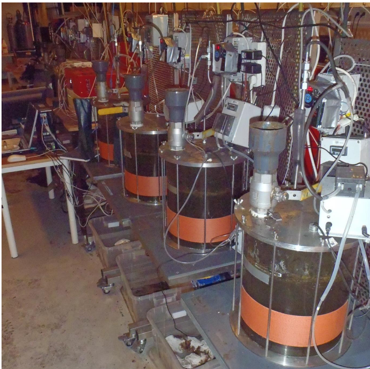
Figur 6-5 Forsøksoppsett slik det var planlagt, med fire CSTR reaktorer påmontert gasstellere, temperaturstyring, omrøring og koblet til GC. Foto: Magnus Gjetmundsen.
