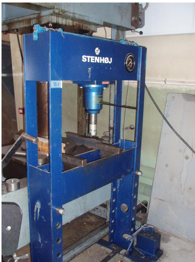
Figur 4.1 - Hydraulisk to-trinns håndpresse ved UMB, IMT
