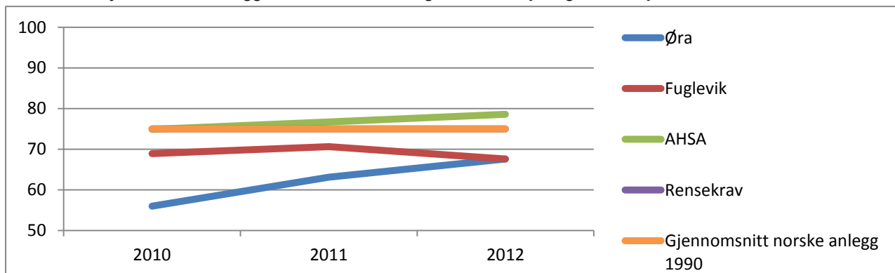
Figur 23 Renseeffekt BOF 5 for alle tre renseanlegg, samt rensekrav (Forurensningsforskriften 2004) og gjennomsnittsverdi for 87 norske kjemiske renseanlegg uten anaerob utråtning av slammet (Ødegaard 1992)
