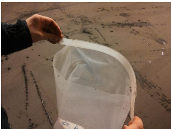
Figur 6.3.2. Dyp pose med stiv kant for vannføringsmåling (Foto: Alexander Pham)
