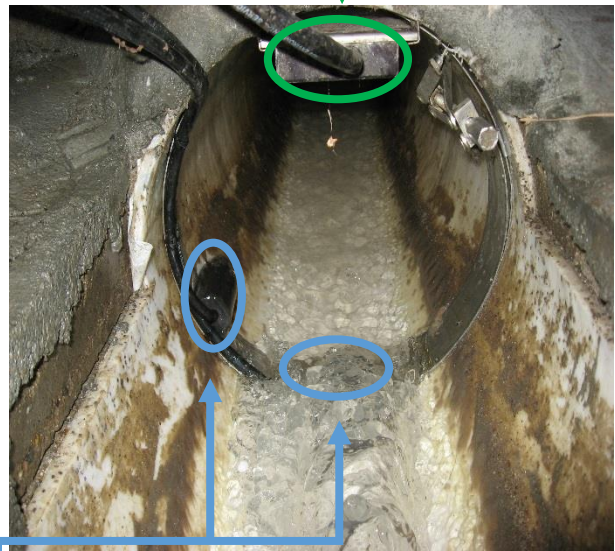
Figur 5.4.2. Figuren illustrerer ADS-målerens måleprinsipp (Foto: Christopher Strauman)
