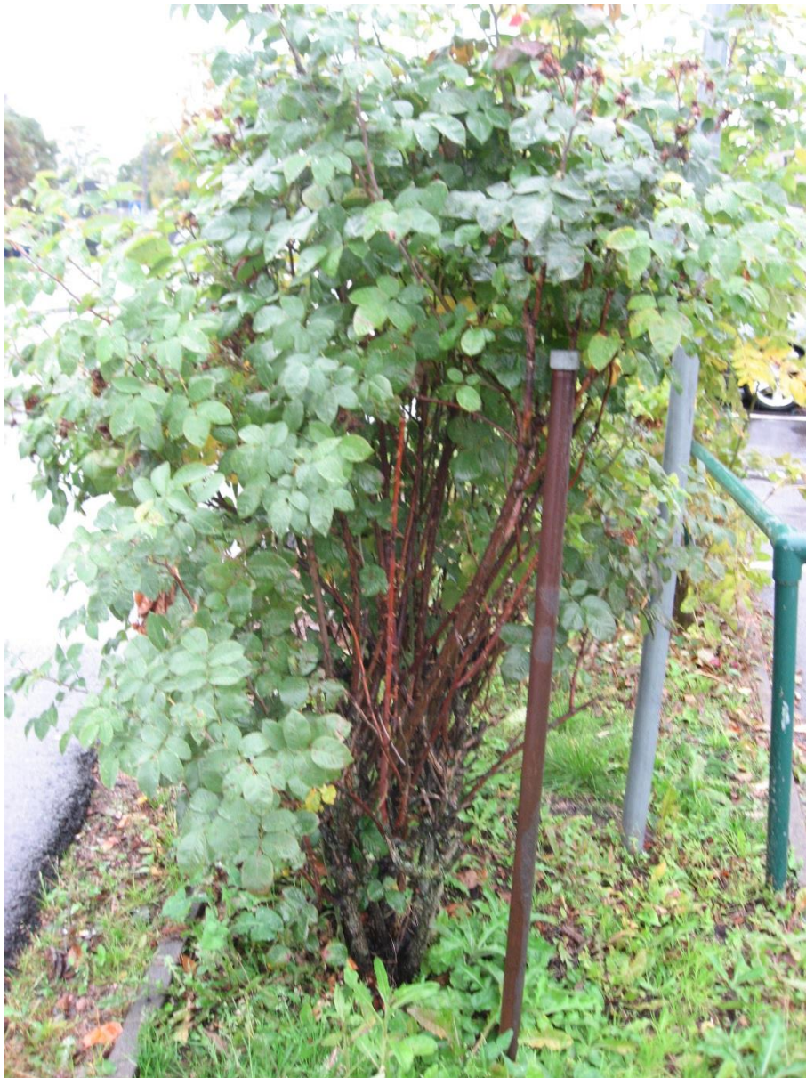
Figur 6.1.3. Peilebrønn for grunnvannsstandmåling (poretrykk) ved John Collets Plass i Oslo, VMAL9_S5 (Foto: Christopher Strauman)
