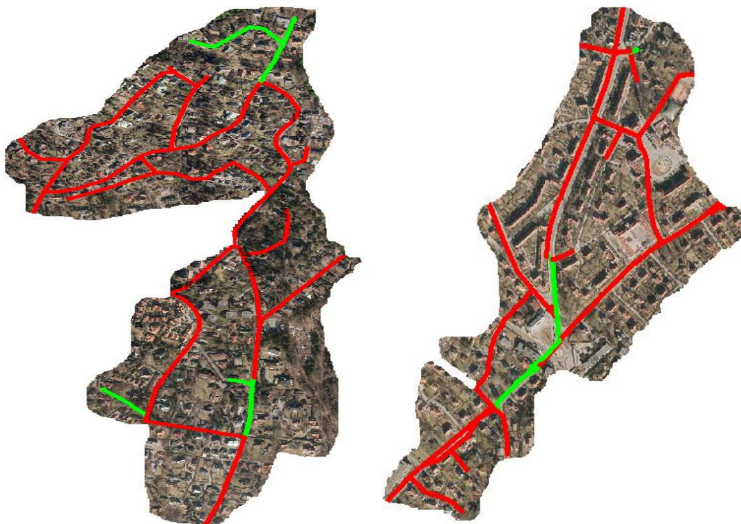
Figur 7.2.1. Fordeling av systemtype i VMAL8_S2 (t.v.) og VMAL9_S5. Rød markerer fellessystemer og grønn separatsystemer.
