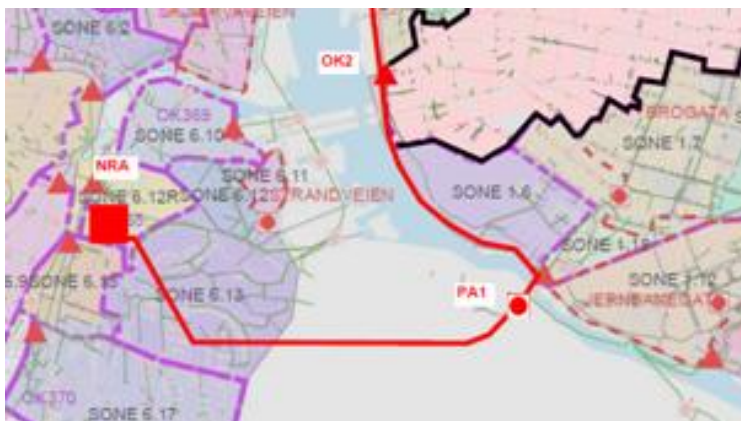
Figur 44: Utdrag fra Figur 18 i kapittel 3.2. Lillestrøm og avløpssone 1.5. Etter OK2 går spillvannet med selvfall til PA1 for så å bli pumpet opp til renseanlegget (NRA).
