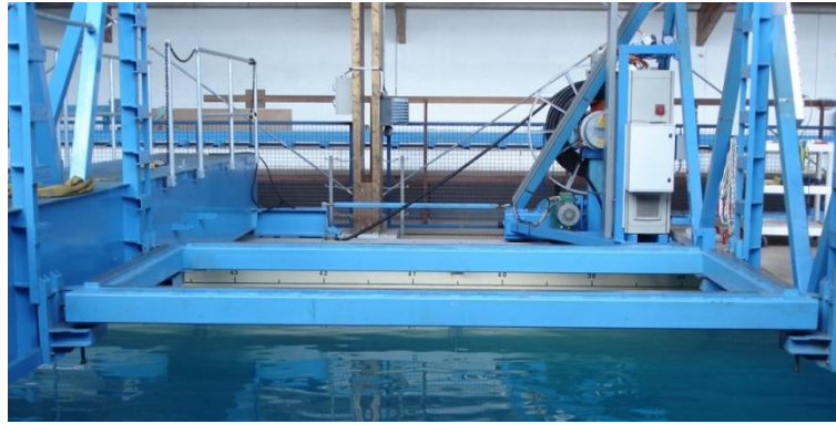
Figur 2.8 Stålramme innspent mellom vognene (Ohana & Le Boulluec 2012)
