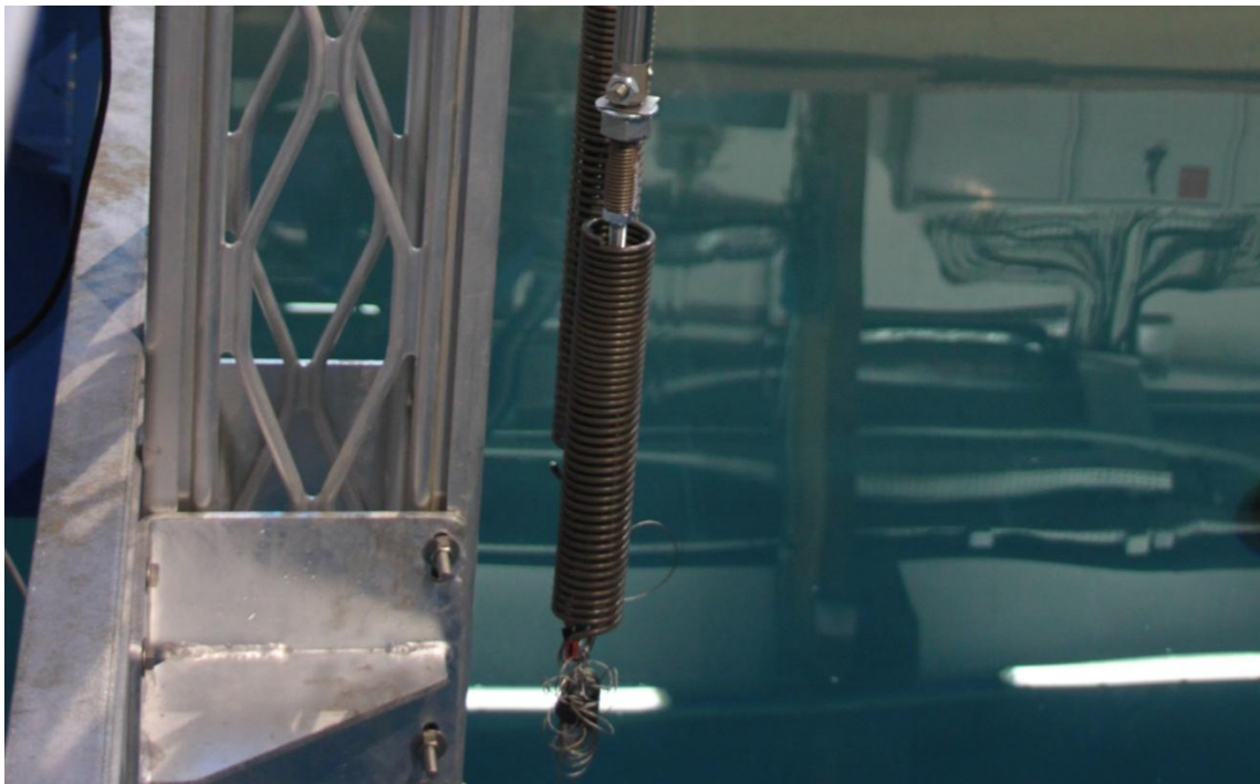
Figur 6.16 Justerbare fjærer for justering av stivhet i forankringslinene
