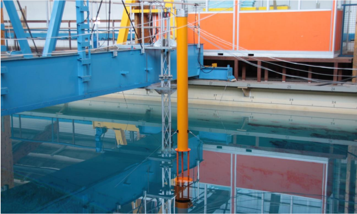
Figur 6.3 TLB-X3 modell i bølgetank
