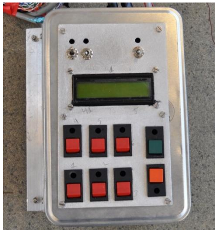
Figur 5.47 Kontrollboks med styresystem og knapper for manuell og automatisk styring
