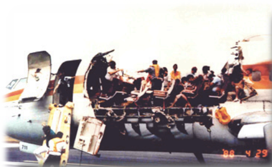
Figur 2: Bildet viser Aloha Airlines ulykken hvor store deler av flyet ble revet av på grunn av sprekkdefekter. Flyulykken skjedde i 1988 [4].
