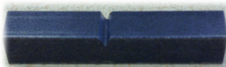
Figur 75: Nærbilde av prøvestaven. Bildet viser tydelig plasseringen av V-sporet.
