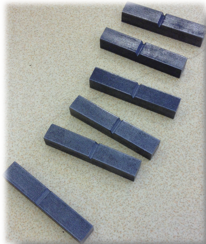
Figur 74: Bildet viser prøvestavene brukt under Charpy slagseighetstesting. Disse er laget i henhold til standardiserte Charpy krav med målene 10x10x55mm og med V-spor.
